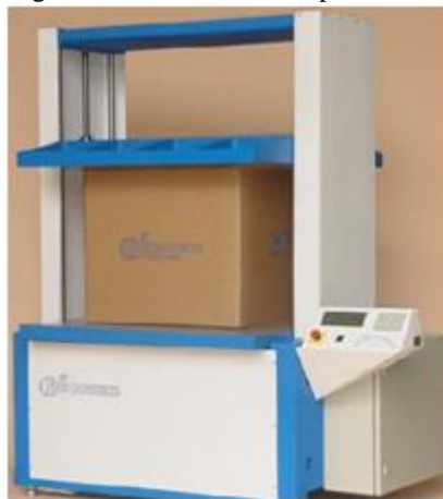
Figura 02 – Ensaio de compressão em embalagens
