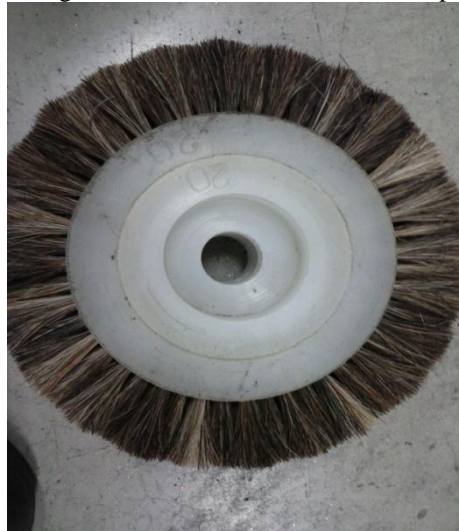
Fotografia 03 – Escova rotativa com corpo de nylon
