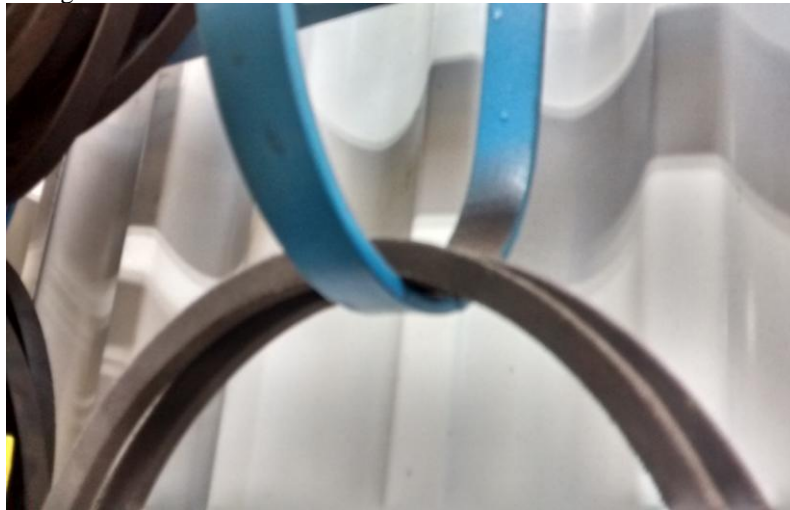
Fotografia 01 – Correia indevidamente armazenada
