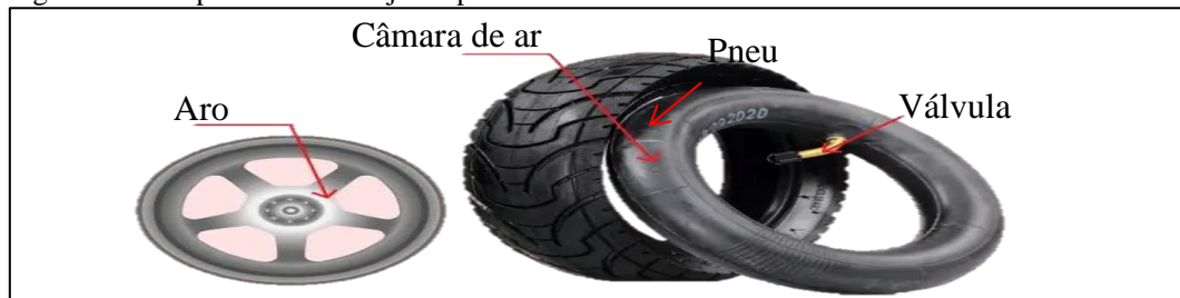
Figura 1 – Componentes do conjunto pneumático.
