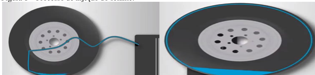
Figura 8 – Processo de injeção do selante.
