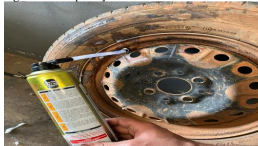
Figura 11 – Aplicação do selante de acordo com as instruções.
