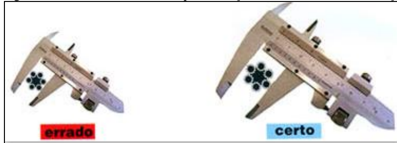
Figura 17 – Procedimento correto para medição do diâmetro do cabo de aço
