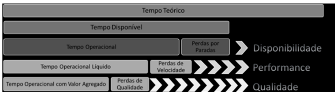
Figura 2 - Relação esquemática dos tempos com as seis grandes perdas e o OEE.
