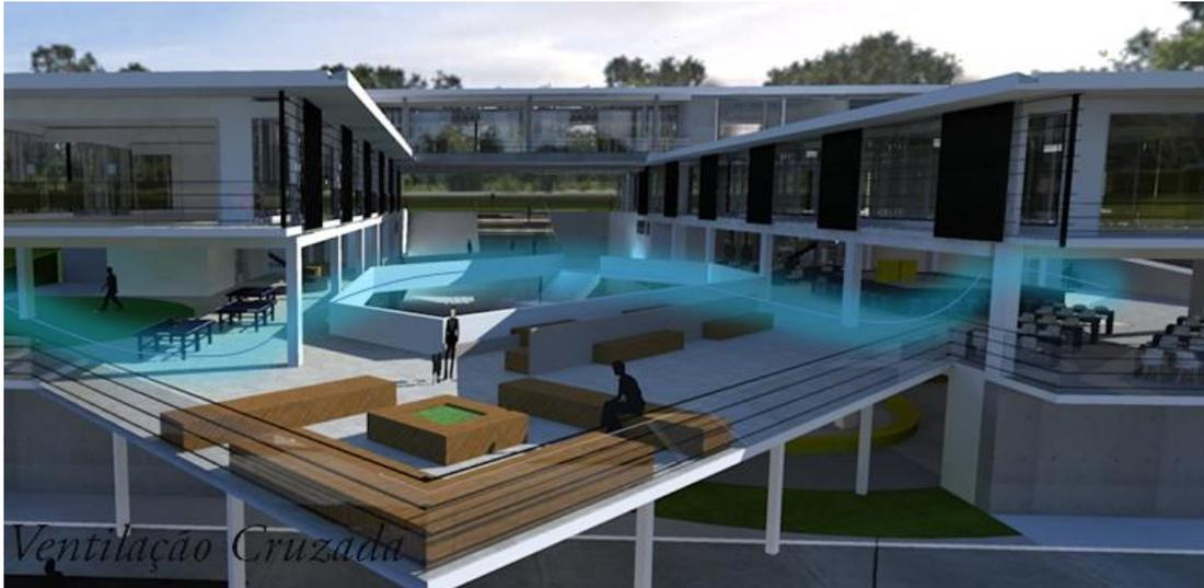
Figura 45 - Representação da ventilação no pavimento do subsolo.
