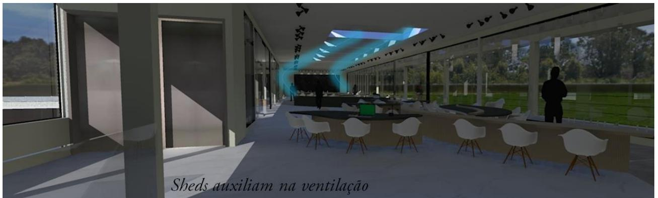
Figura 49 - Representação da ventilação através dos sheds no pavimento superior.
