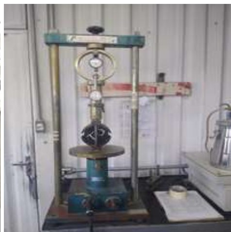
Figura 9: Rompimento de CPs a compressão
