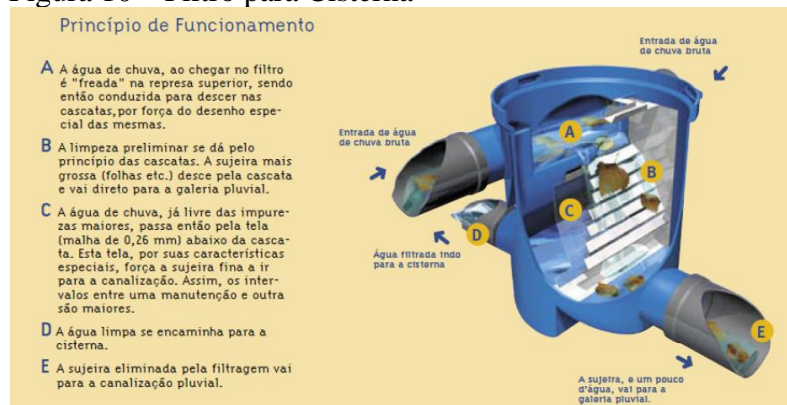
Figura 10 – Filtro para Cisterna
