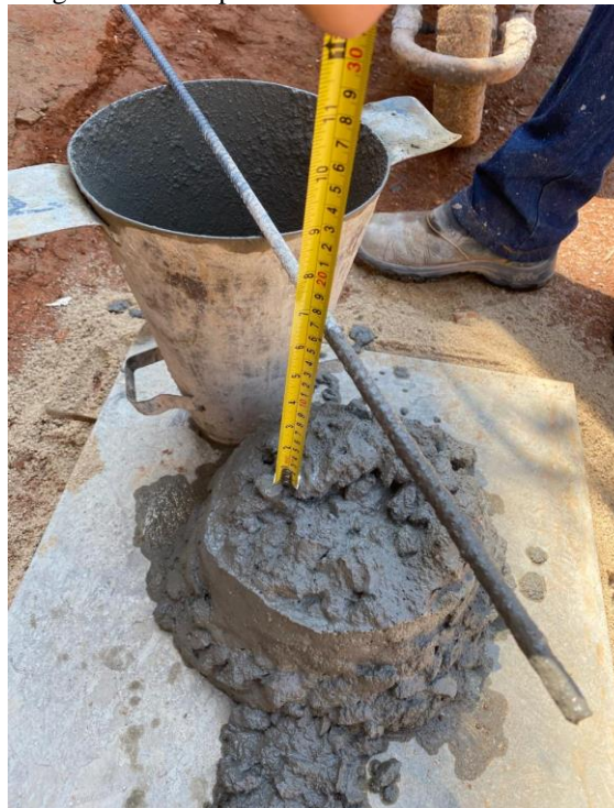
Figura 10: Slump Test do concreto convencional.
