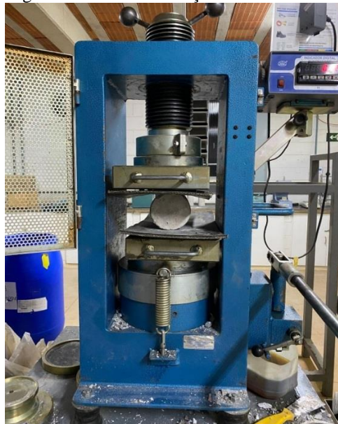
Figura 15: Ensaio de Tração.
