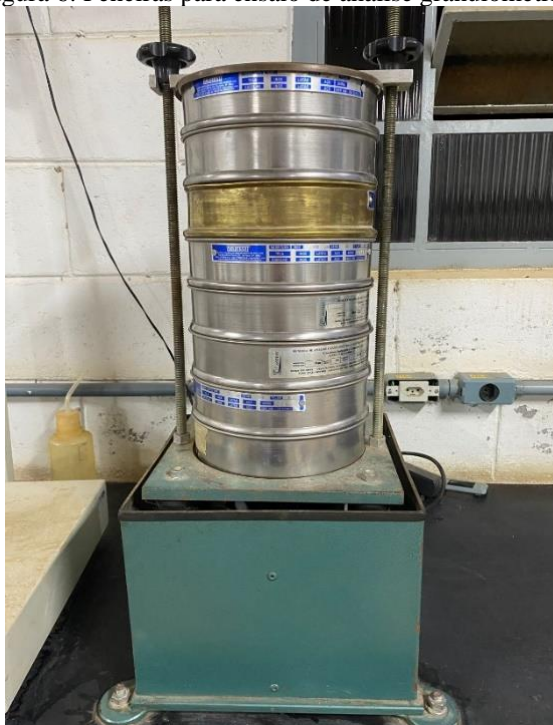
Figura 6: Peneiras para ensaio de análise granulométrica.
