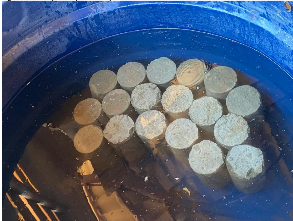
Figura 13: Corpos de prova em processo de cura.
