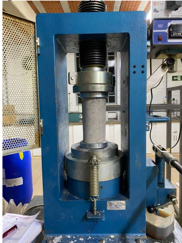
Figura 14: Ensaio de Compressão.
