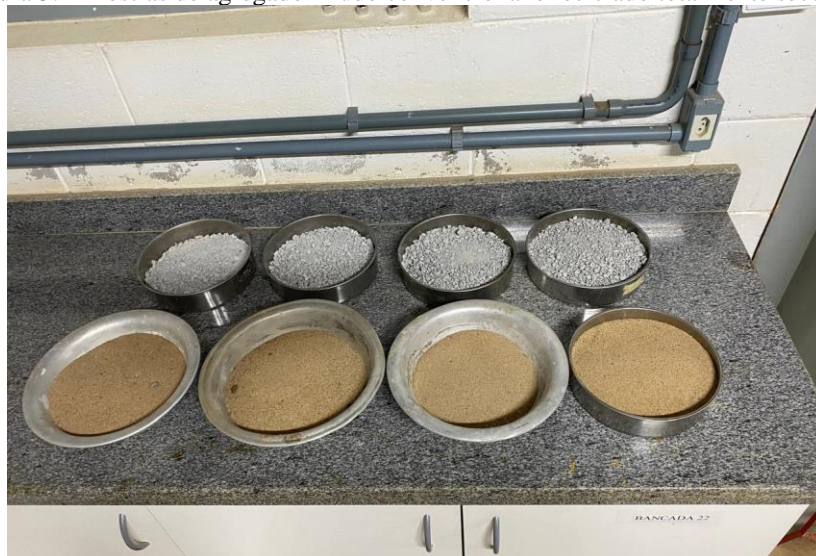
Figura 5: Amostras de agregado miúdo convencional e reciclado totalmente seco.
