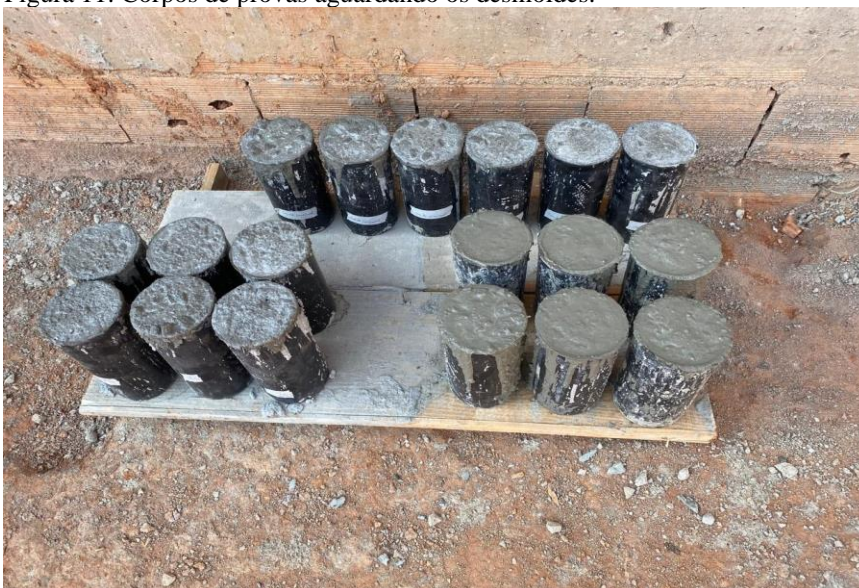
Figura 11: Corpos de provas aguardando os desmoldes.
