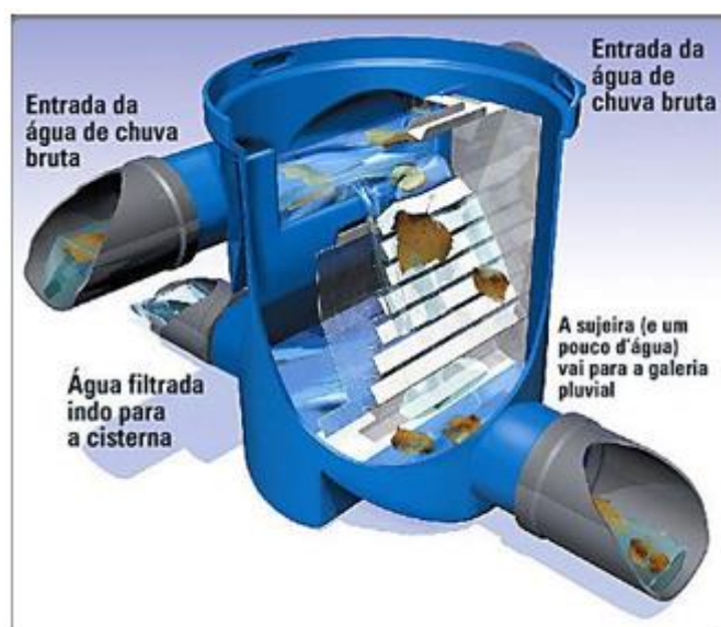
Figura 7: Processo de filtragem para água pluvial.
