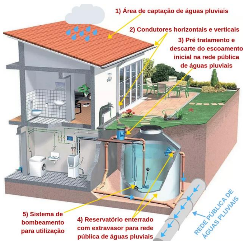
Figura 3 - Sistema de captação e aproveitamento de águas pluviais conforme a NBR 15527
