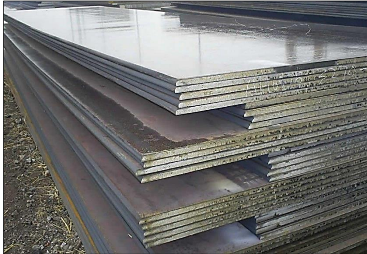
Figura 8: Chapas de aço estrutural.
