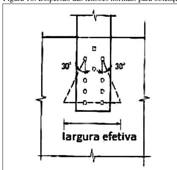
Figura 16: Dispersão das tensões normais para obtenção da seção efetiva.
