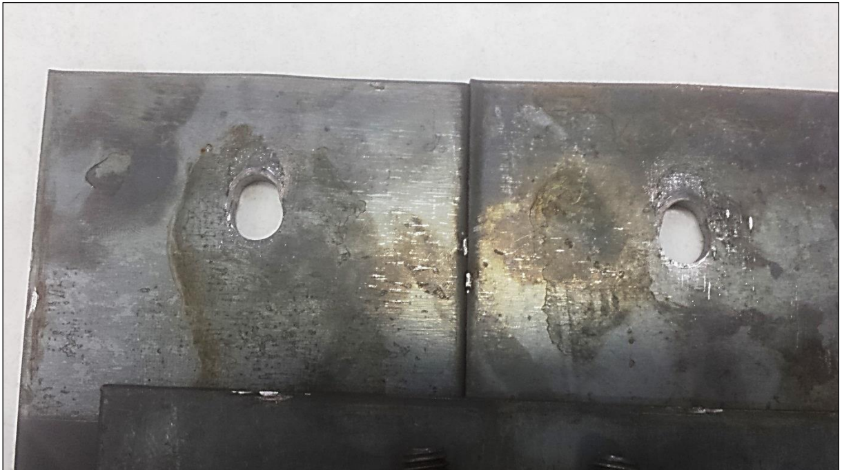
Figura 42: Ovalização do furo na ligação parafusada.
