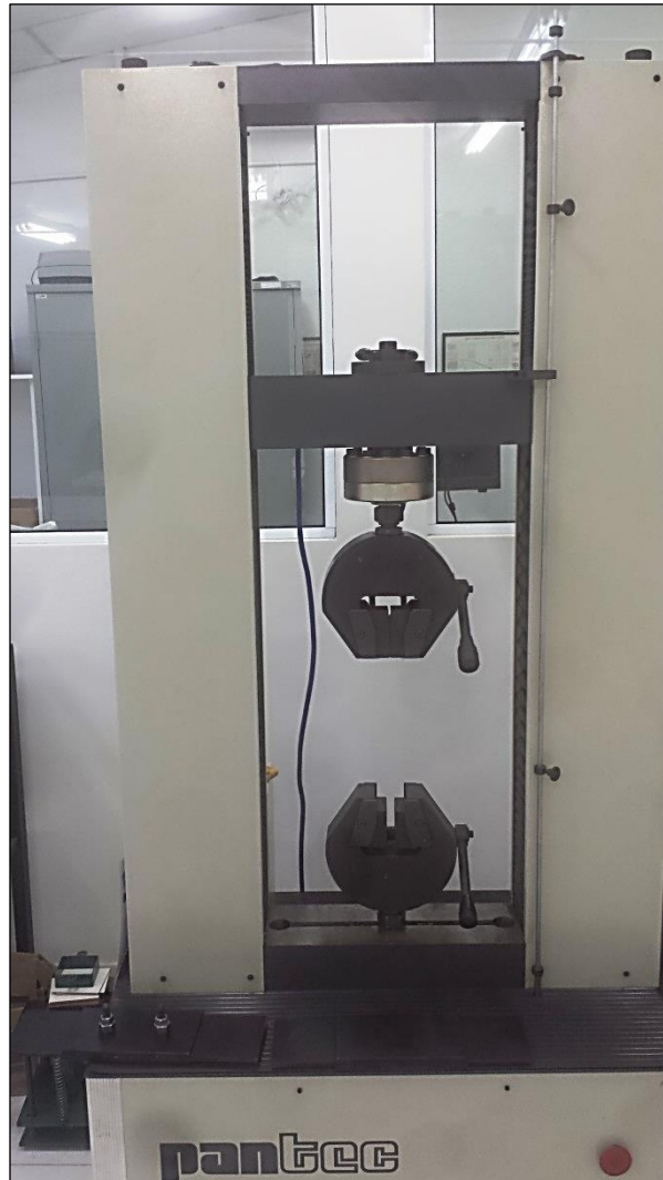
Figura 38: Equipamento usado para tracionar os corpos de prova.
