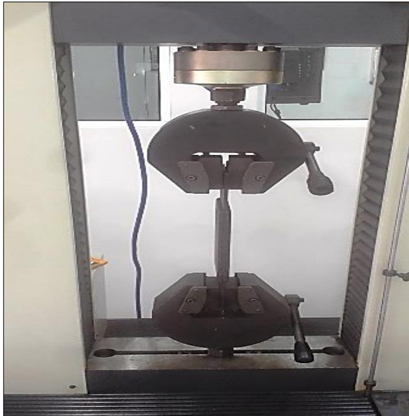
Figura 41: Chapa soldada sofrendo esforço de tração.
