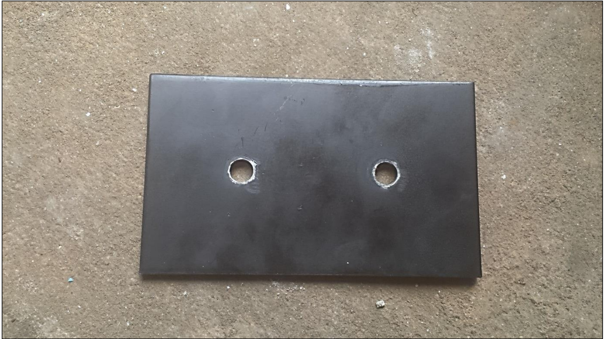
Figura 33: Furo padrão adotado na chapa de aço.
