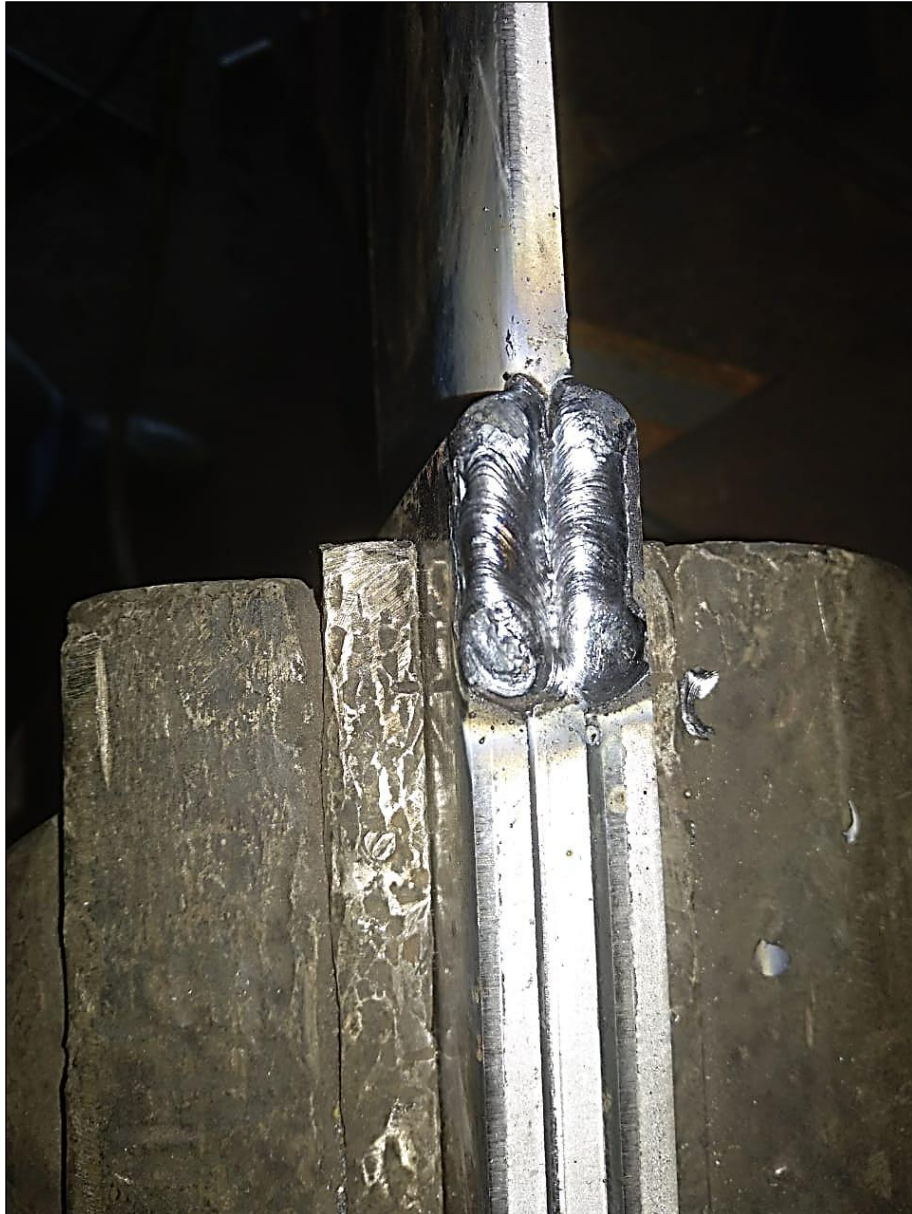
Figura 34: Solda de filete aplicada no protótipo.
