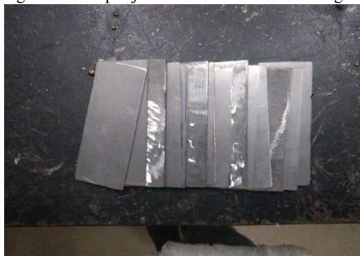
Figura 11: Chapas já cortadas e iniciando montagem
