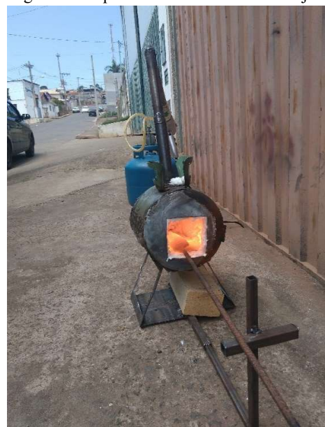
Figura 15: Aquecimento da barra a ser forjada
