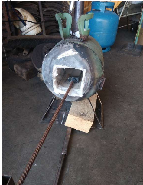
Figura 14: Barra a ser forjada na forja
