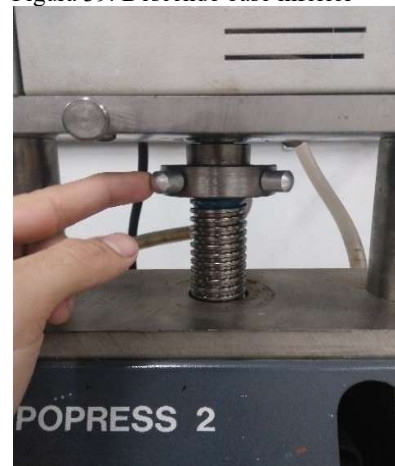
Figura 39: Descendo base inferior
