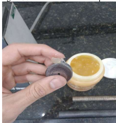
Figura 30: Passando vaselina na parede lateral
