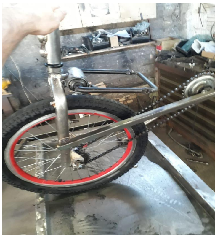
Figura 9 – Teste da alavanca de bombeamento
