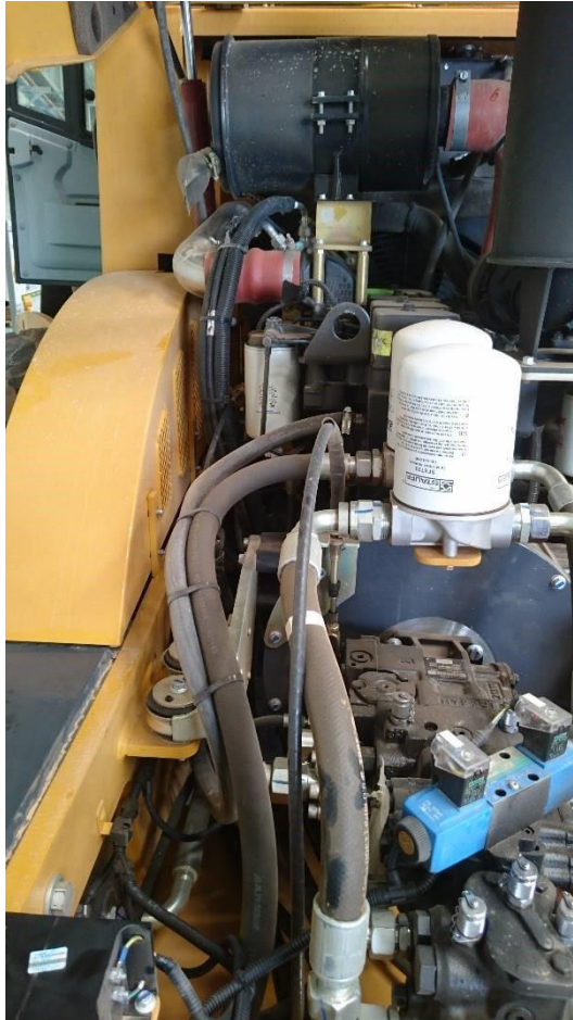
Figura 01: Obstrução na acessibilidade de manutenção. Fonte: O Autor.
