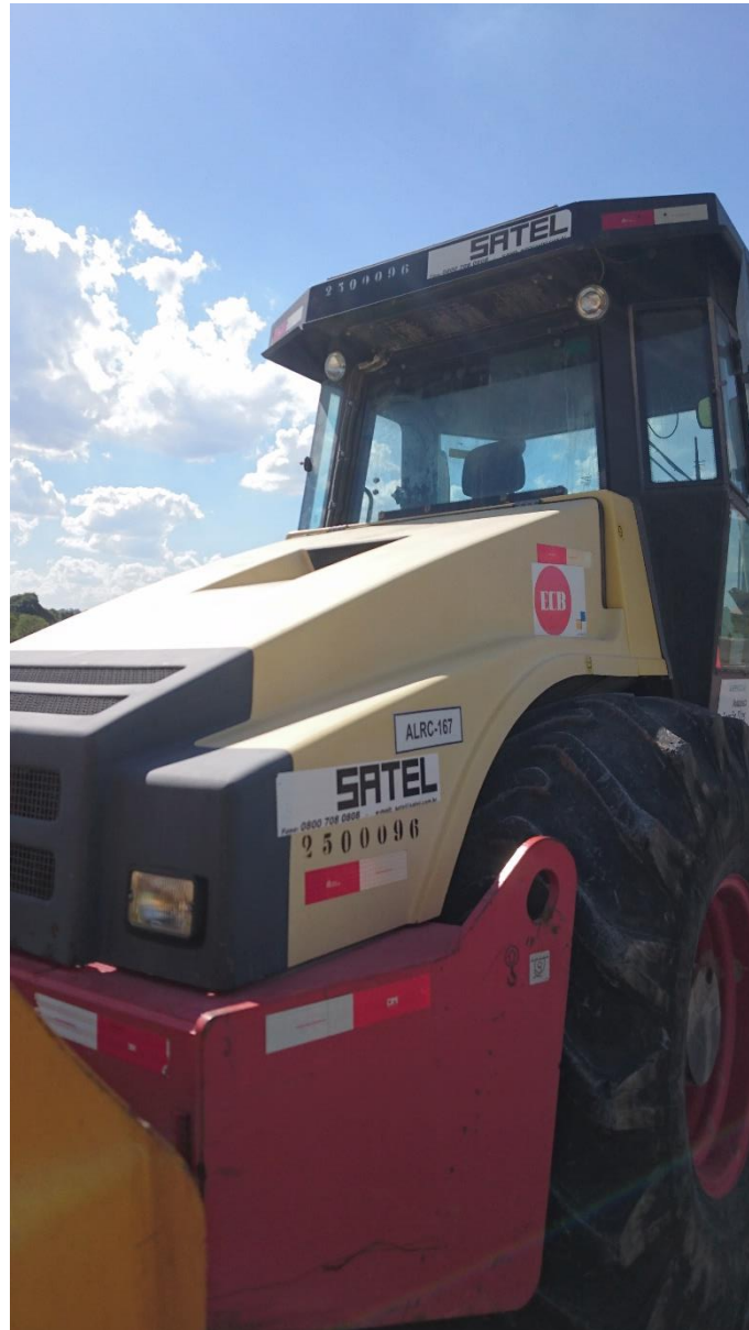
Figura 04: Aplicação de Fibra de vidro em máquinas. Fonte: O autor.
