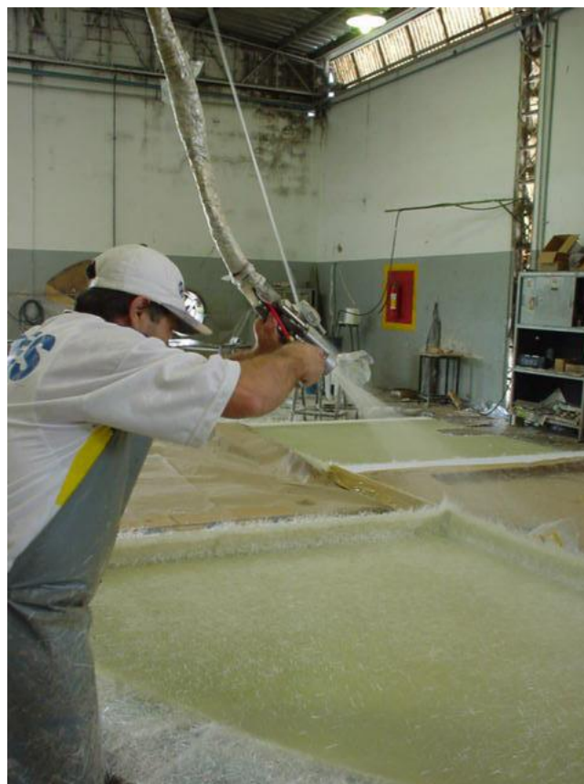
Figura 07: Aplicação do processo Spray up. Fonte: Ancel tecnologia
