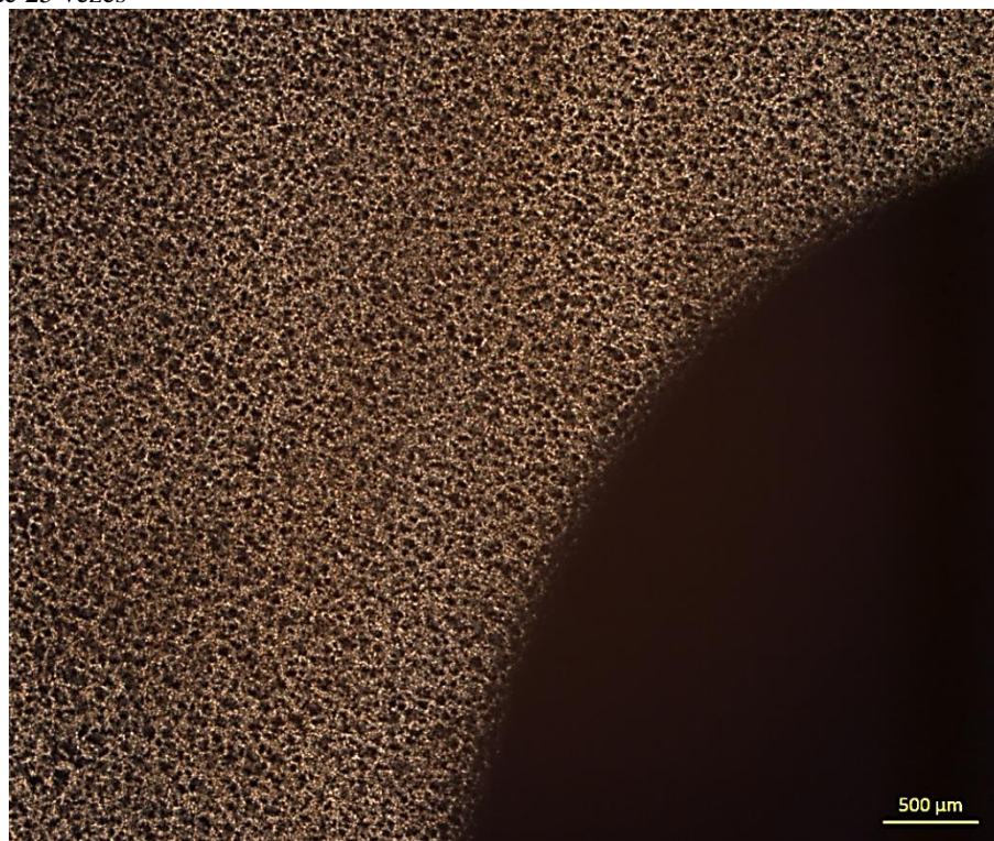
Figura D. 1 - Imagem metalográfica da região 1 - porção interna da dobra - aproximação de 25 vezes
