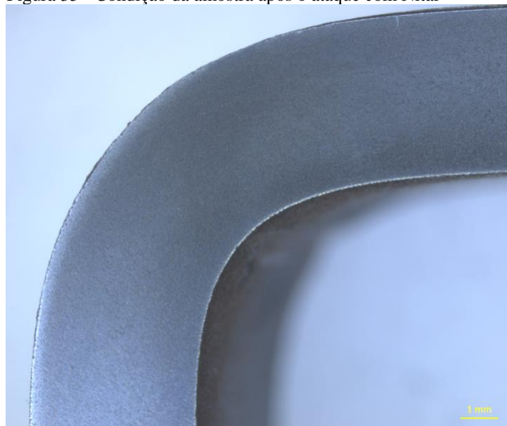
Figura 35 - Condição da amostra após o ataque com Nital
