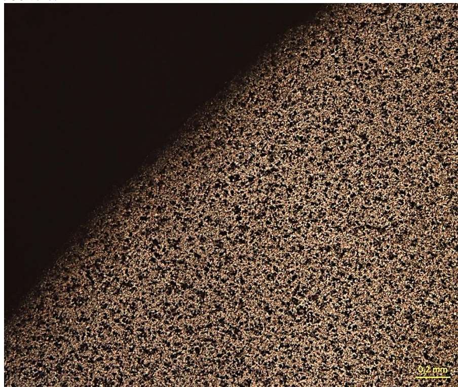
Figura D. 18 - Imagem metalográfica da região 3 - porção externa da dobra - aproximação de 50 vezes
