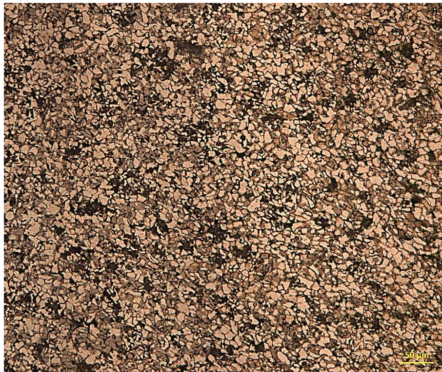
Figura D. 4 - Imagem metalográfica da região 1 - porção interna da dobra - aproximação de 200 vezes
