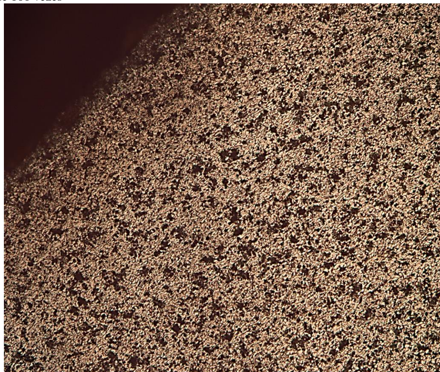
Figura D. 19 - Imagem metalográfica da região 3 - porção externa da dobra - aproximação de 100 vezes
