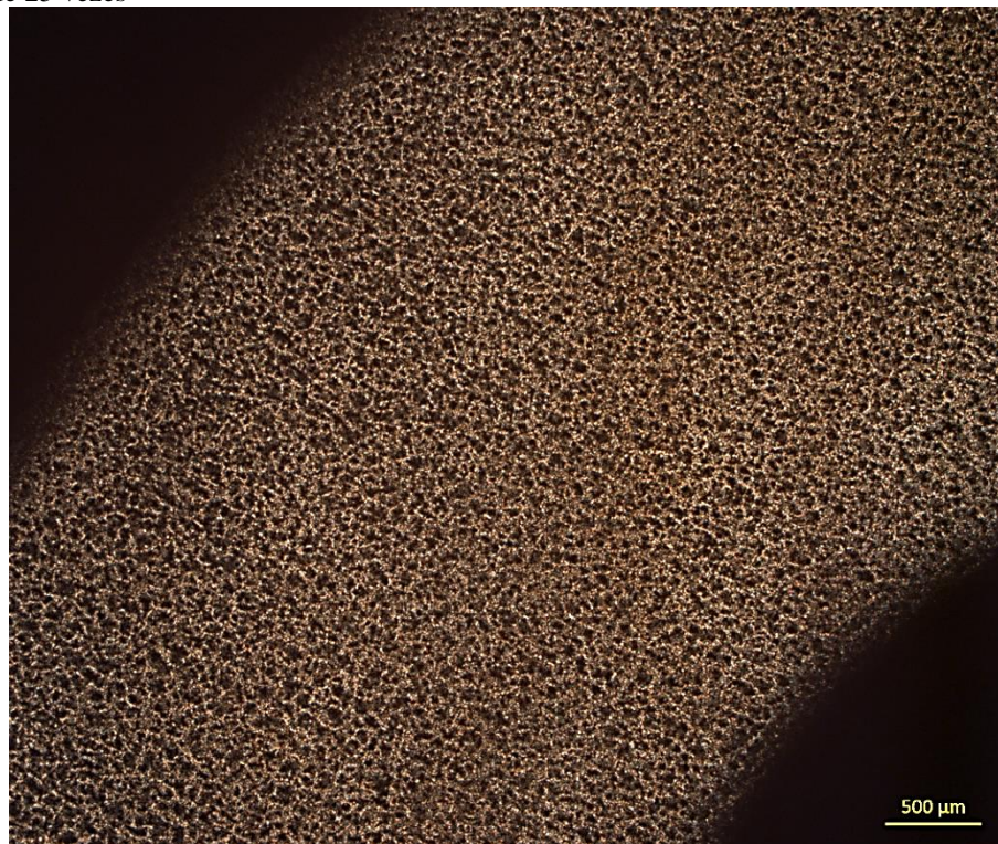
Figura D. 9 - Imagem metalográfica da região 2 - porção mediana da dobra - aproximação de 25 vezes
