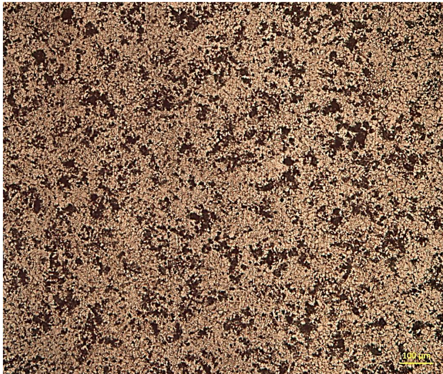
Figura D. 35 - Imagem metalográfica da região 5 - porção mediana da chapa - aproximação de 100 vezes
