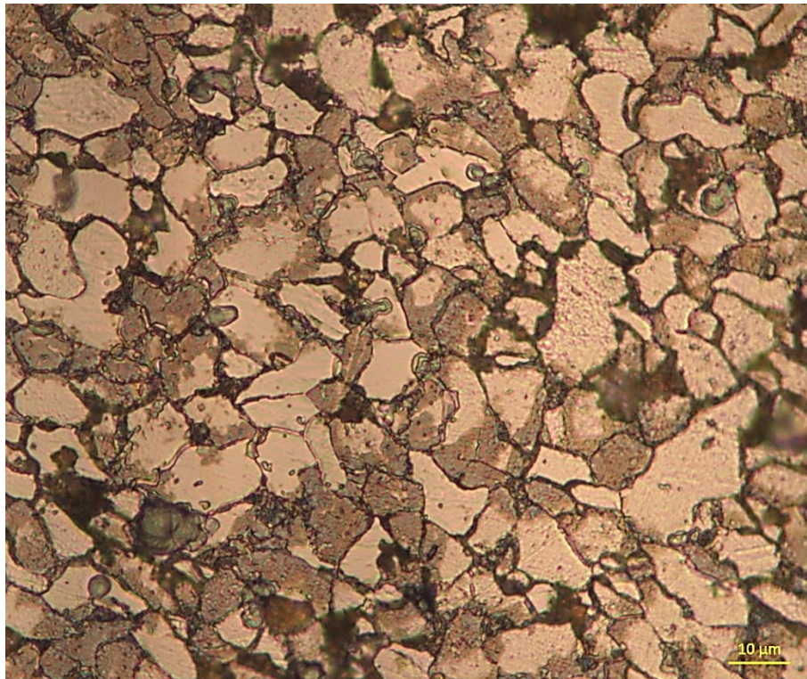
Figura D. 7 - Imagem metalográfica da região 1 - porção interna da dobra - aproximação de 1000 vezes
