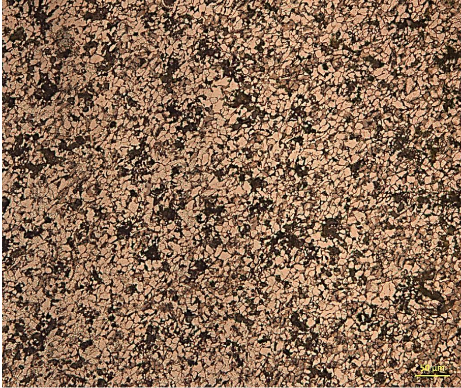
Figura D. 12 - Imagem metalográfica da região 2 - porção mediana da dobra - aproximação de 200 vezes
