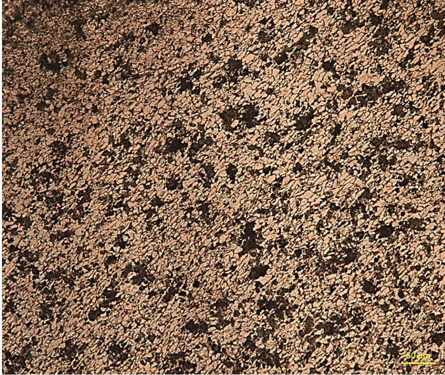
Figura D. 20 - Imagem metalográfica da região 3 - porção externa da dobra - aproximação de 200 vezes
