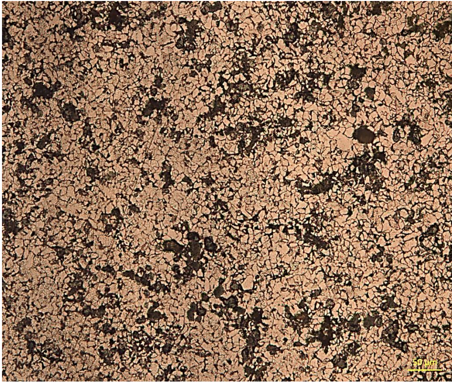
Figura D. 36 - Imagem metalográfica da região 5 - porção mediana da chapa - aproximação de 200 vezes
