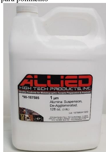
Figura 33 - Alumina em suspensão para polimento
