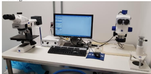
Figura 36 - Microscópio e computador auxiliar para análise metalográfica
