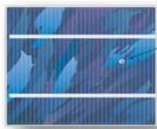
Figura 58: Ponto-quente em uma célula fotovoltaica
