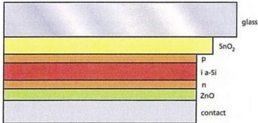
Figura 34: Representação de uma célula de silício amorfo
