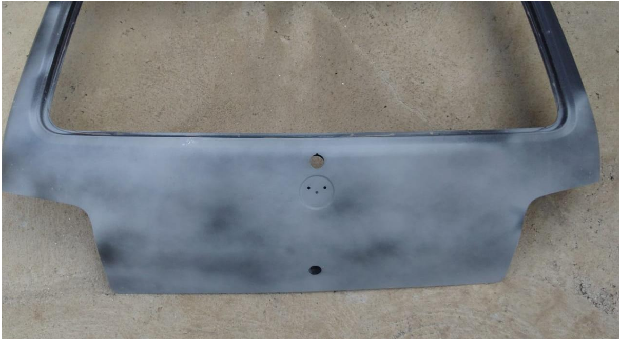
Figura 04 - Aplicação do primer em toda a superfície
