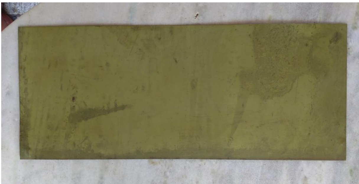
Figura 08 - Wash primer aplicado no corpo de prova
