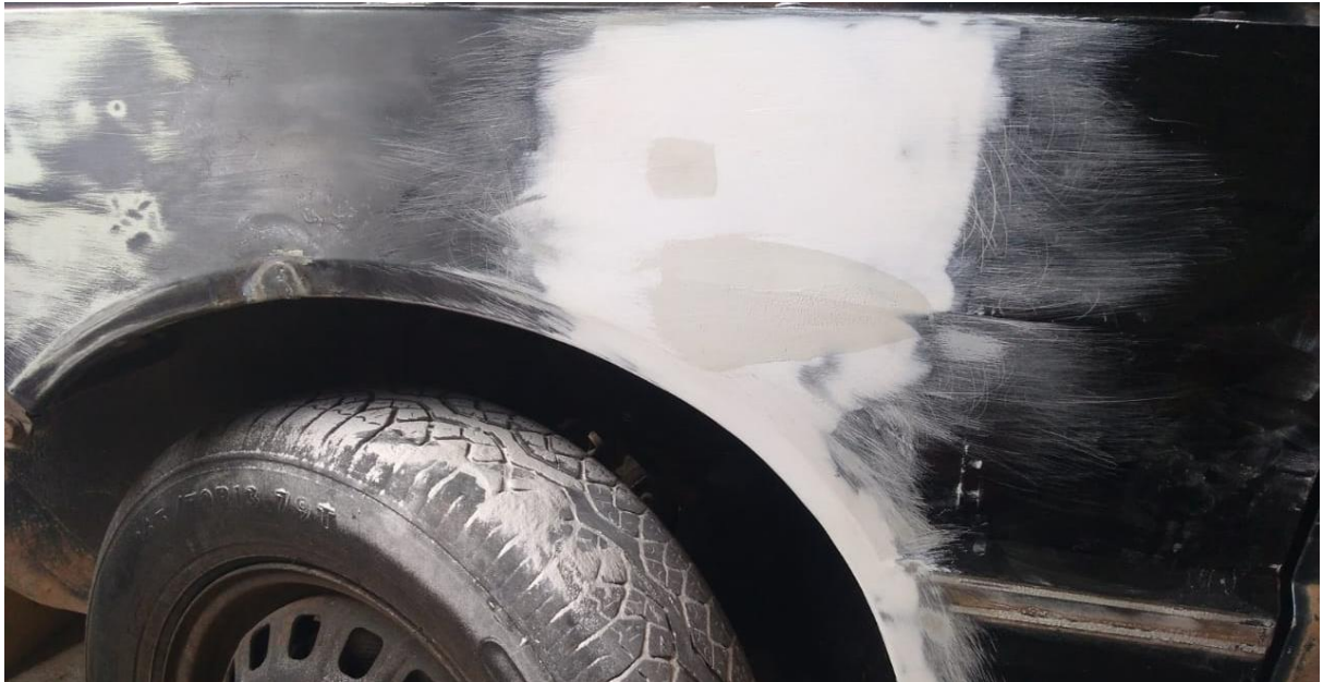
Figura 03 - Alinhamento e aplicação da massa para correção da superfície
