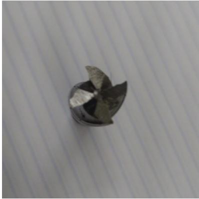
Figura 11: fresa nacional antes da usinagem
