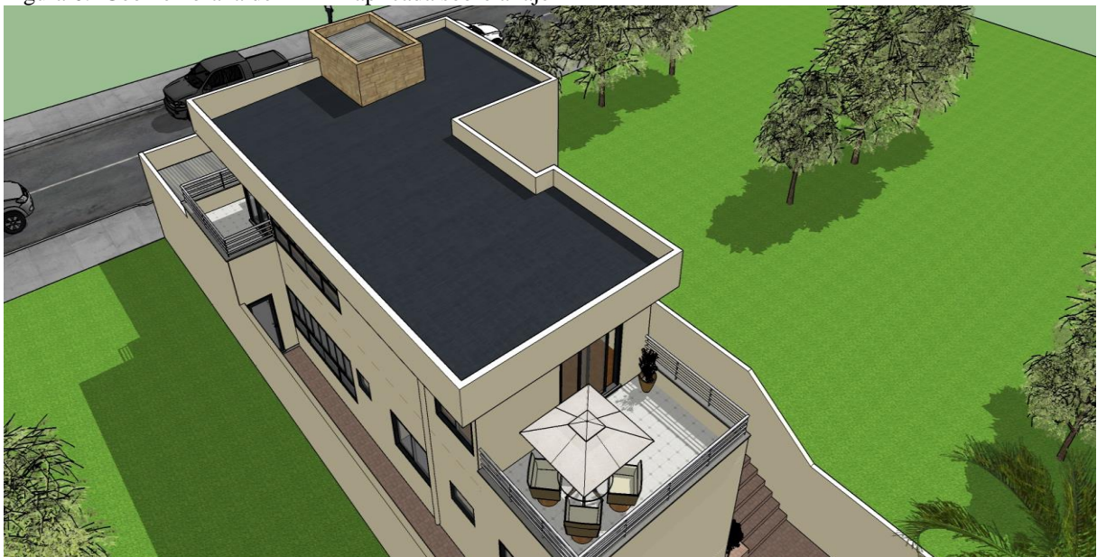
Figura 6: Geomembrana de PEAD aplicada sobre a laje
