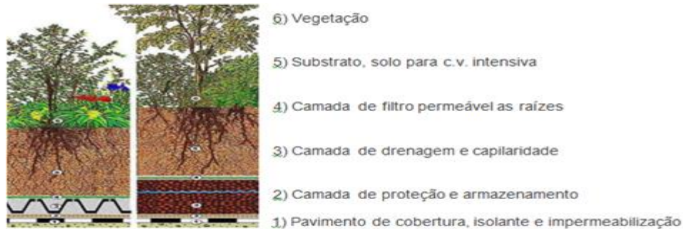
Figura 01: Camadas de um telhado extensivo
