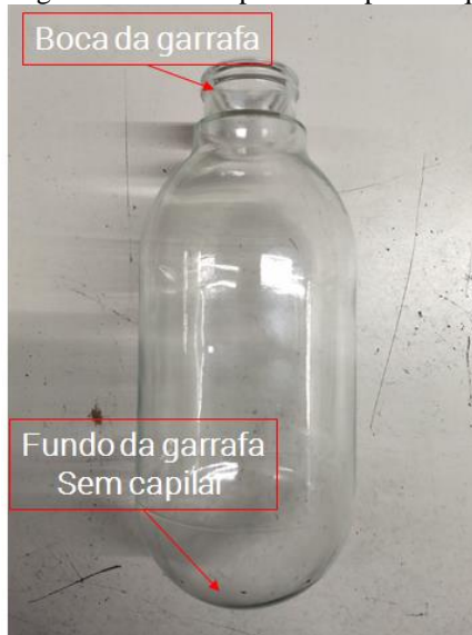
Figura 9 – Garrafa produzida pela máquina IS.
