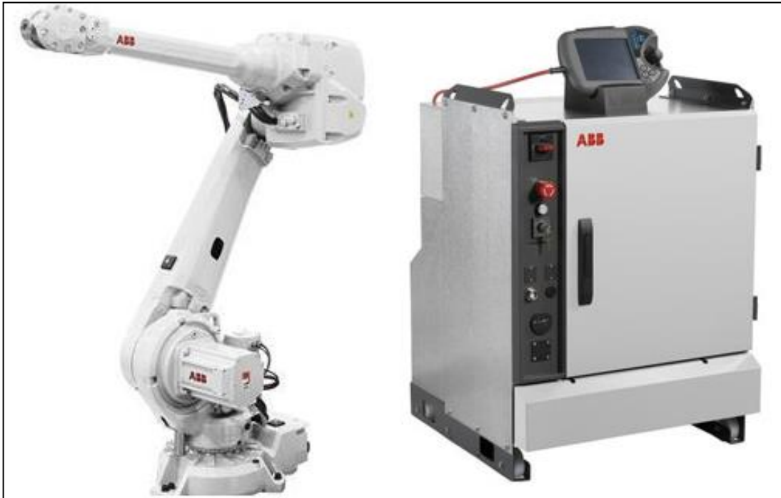
Figura 3 – Robô ABB IRB 2600 e seu Controlador ABB IR5.
