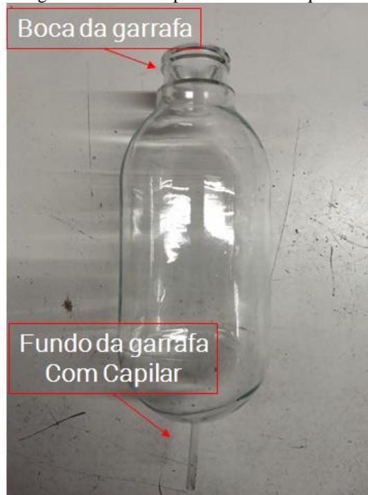
Figura 11 – Garrafa processada na máquina Tubular.
