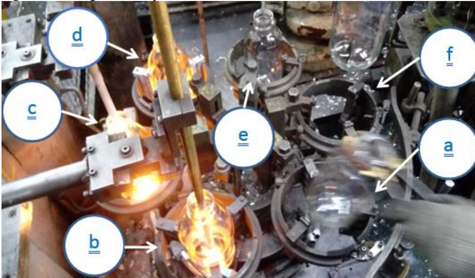
Figura 10 – Estágios da Máquina Tubular.
