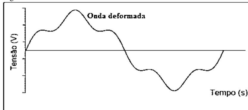
Figura 12 – Onda resultante da soma da onda da tensão e da harmônica n = 5
