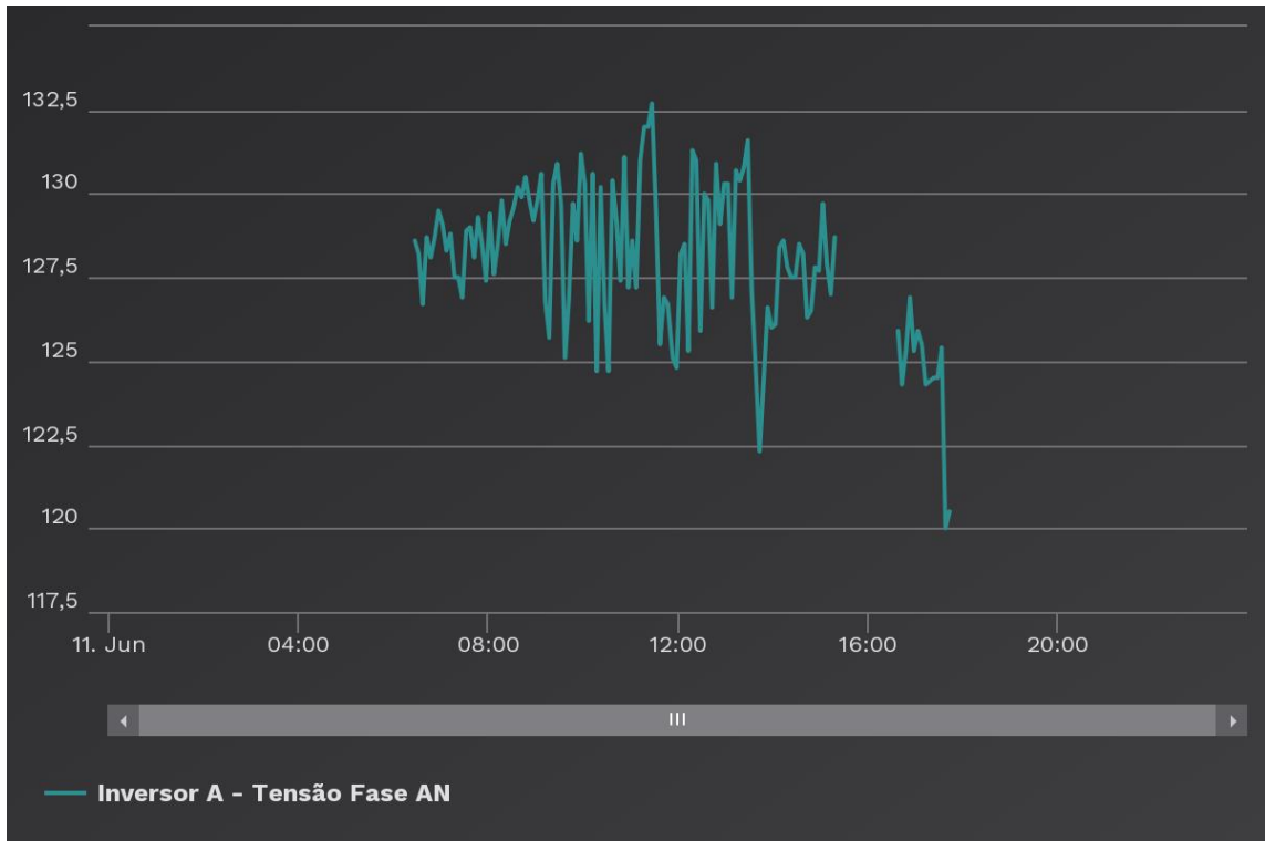
Figura 30: Tensão (V) entre fases referentes a avaria encontrada no dia 11/06/2018
