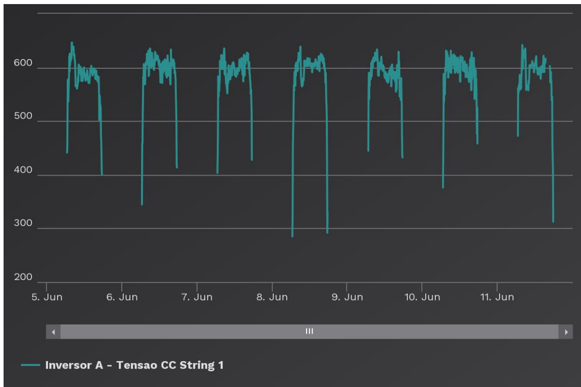
Figura 178: Tensão (V) da string em CC referente a semana do dia 05/06/2018 a 11/06/2018
