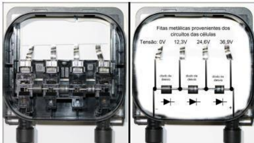
Figura 16 - Caixa de Conexão
