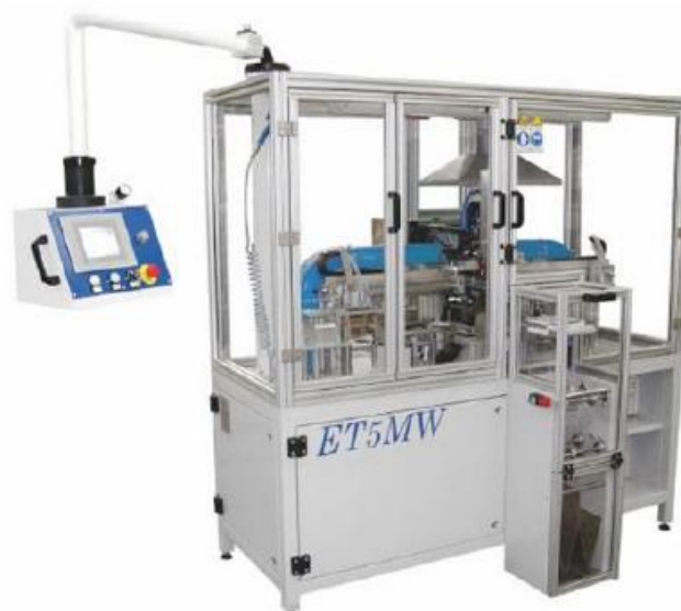
Figura 13 - Máquina que realiza conexão das células
