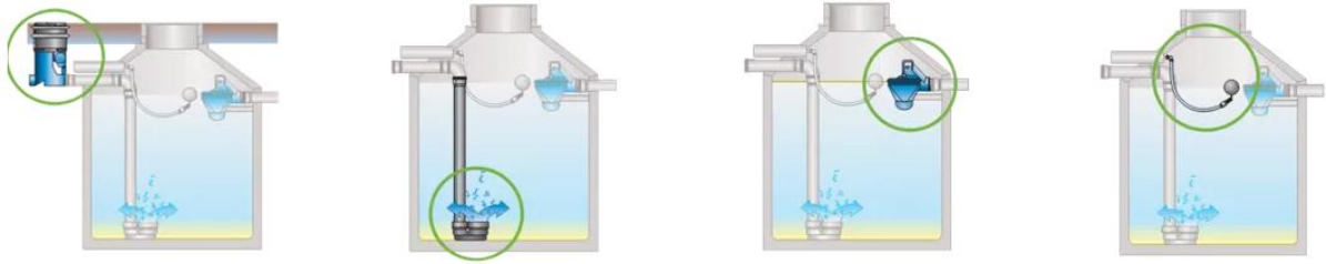
Figura 6. Esquema do filtro, freio de água, sifão ladrão e boia de sucção, respectivamente.
