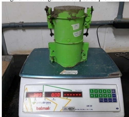
Figura 17 – Pesagem dos corpos-de-prova no estado fresco.
