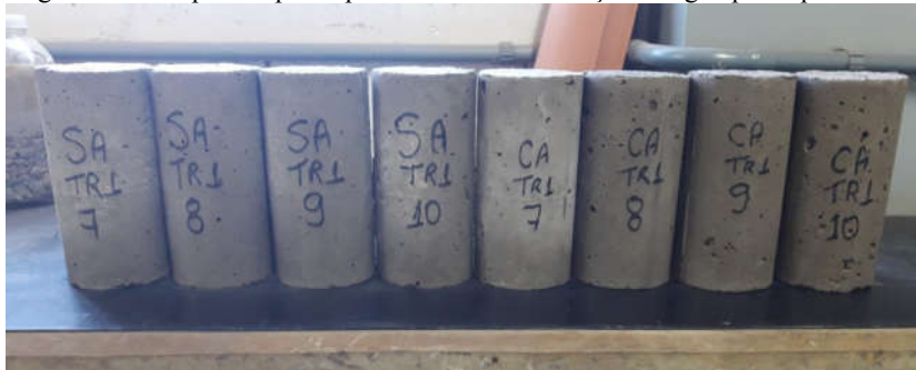
Figura 20 – Corpos-de-prova para o ensaio de absorção de água por capilaridade.
