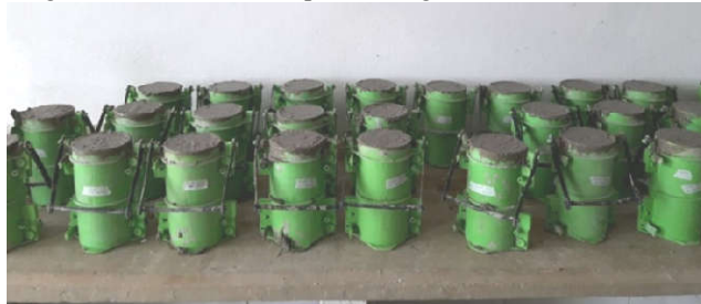
Figura 16 – Cura inicial após moldagem.
