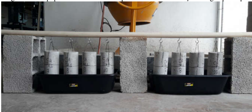
Figura 21 – Equipamento desenvolvido para o ensaio de absorção de água por capilaridade.
