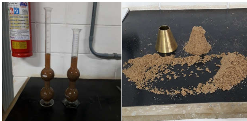
Figura 13 (a) – Massa específica conforme ABNT NBR 9776:1987; (b) massa específica conforme ABNT NBR NM 52:2009.
