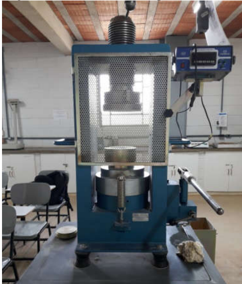
Figura 19 – Prensa hidráulica para o ensaio de resistência à compressão.
