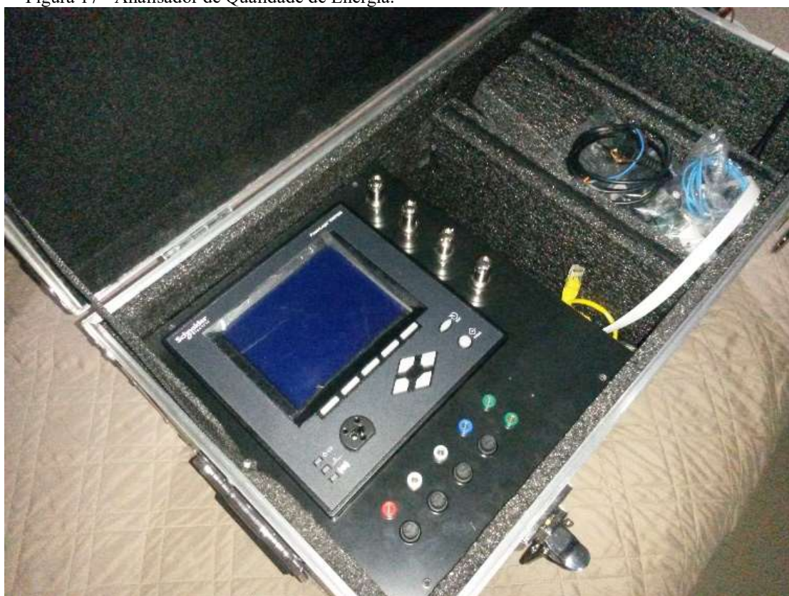
Figura 17 - Analisador de Qualidade de Energia.
