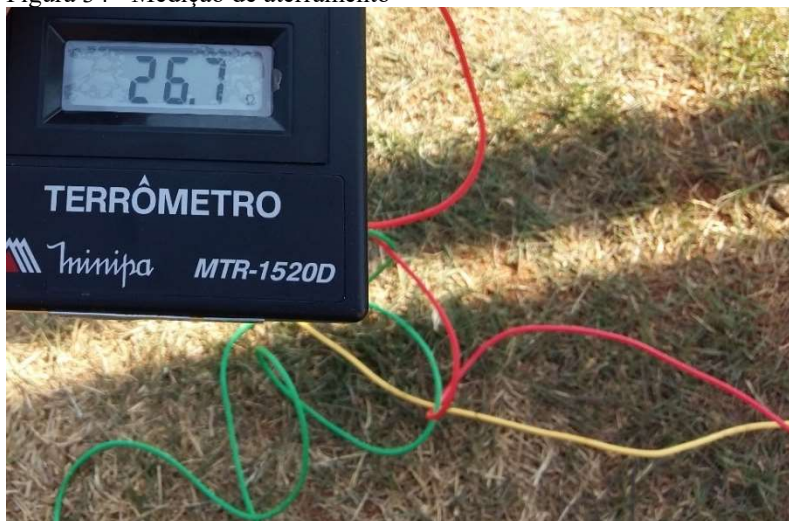
Figura 34 - Medição de aterramento
