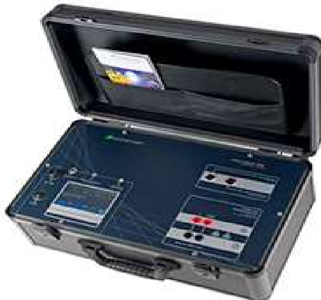
Figura 20 - Traçador de Curva IxV.
