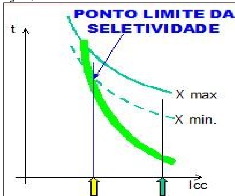
Figura 13: Curva de seletividade alimentador Elo fusível
