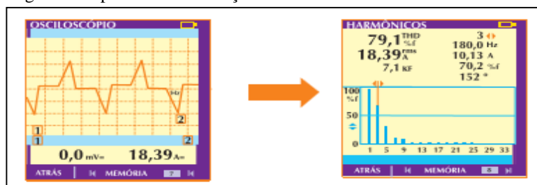
Figura 5: Espectro com distorção harmônico
