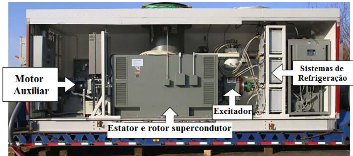
Figura 3: Compensador Síncrono SuperVar.
