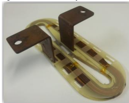
Figura 5: Bobina de fita supercondutora
