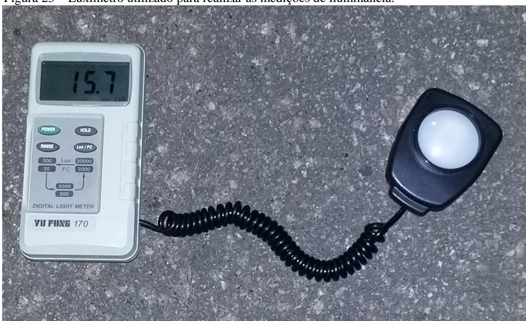
Figura 23 – Luxímetro utilizado para realizar as medições de iluminância.
