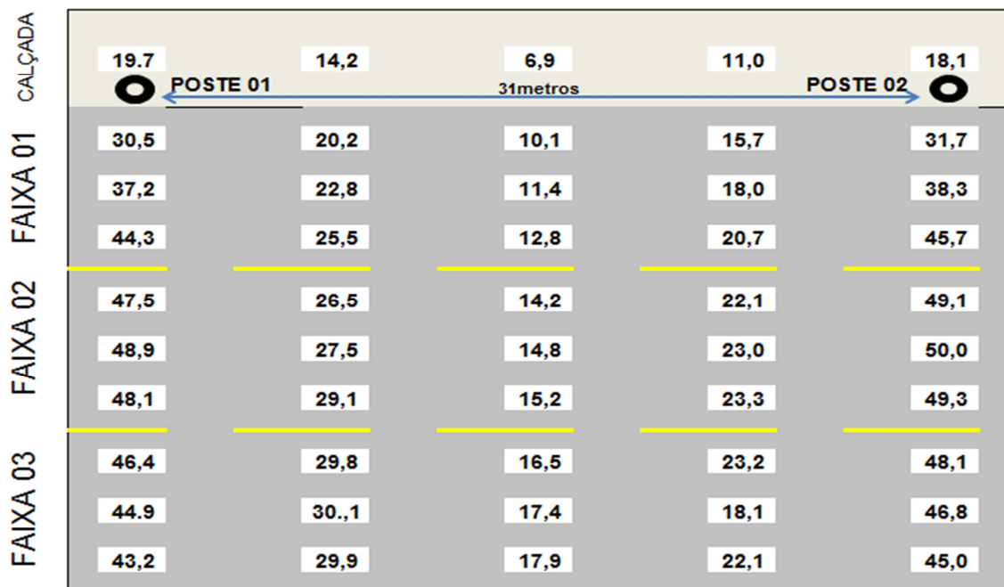
Figura 25 – Grade completa da medição luminotécnica - LED
