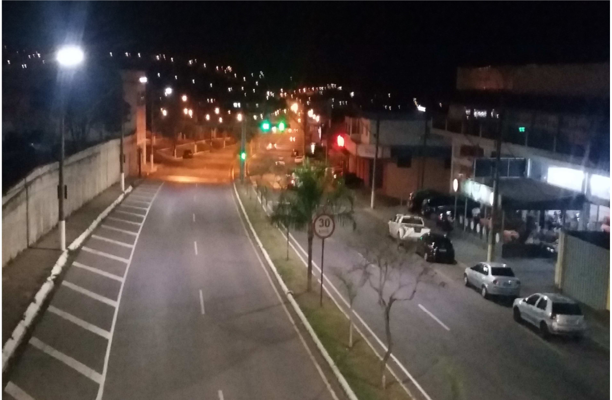
Figura 28 – Foto do local de transição entre a tecnologia VSAP para a tecnologia LED
