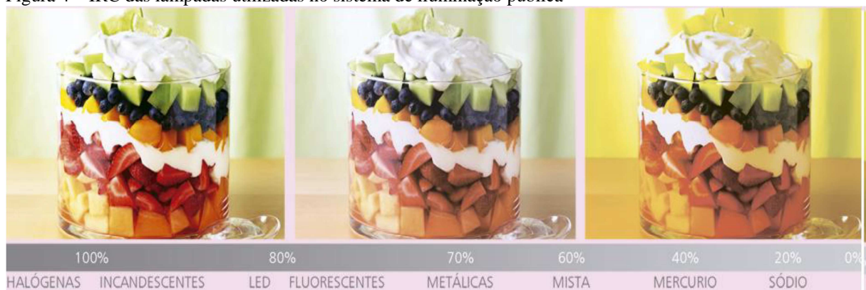
Figura 4 – IRC das lâmpadas utilizadas no sistema de iluminação pública
