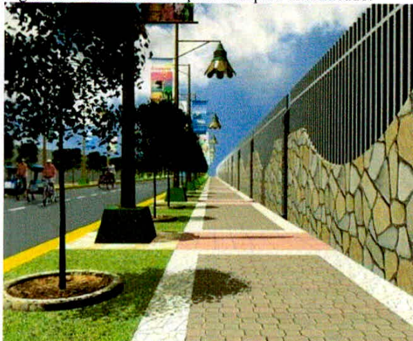
Figura 102: Modelo de calçada com piso intertravado.
