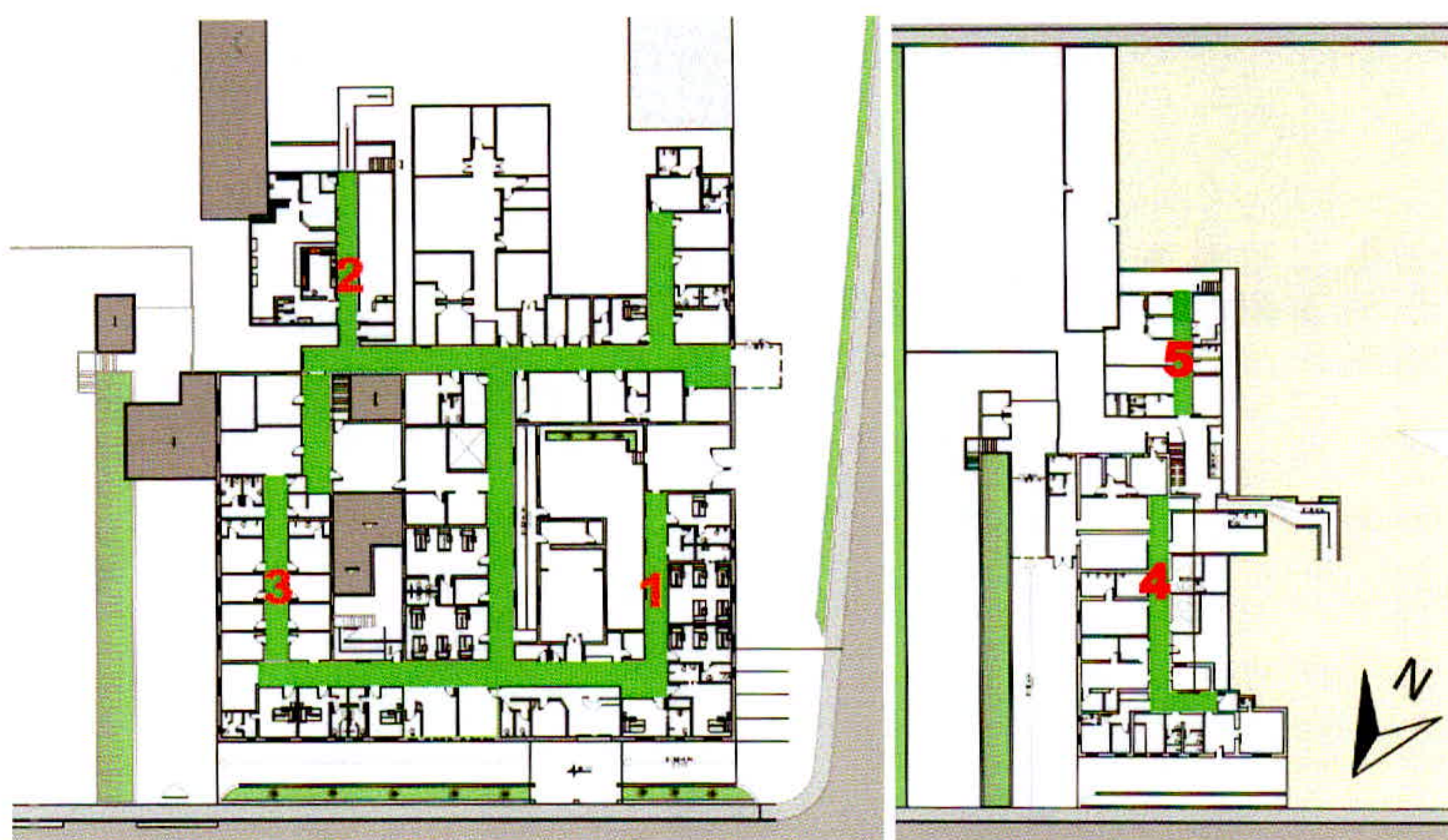
Figura 58 – Planta de identificação dos corredores com dimensões menores que 2,00 m, sem escala (ver Apêndice A). Fonte: a autora, 2015.
