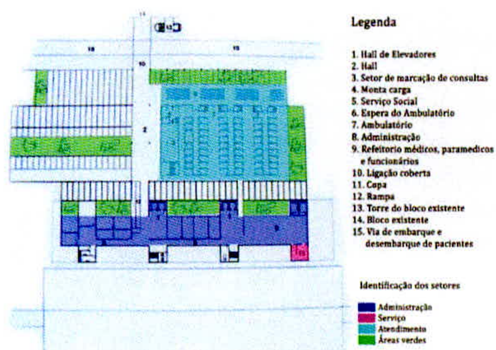
Figura 35 – Planta de setorização - Nível 0,00. Fonte: FEITOZA, T.B (2011).
