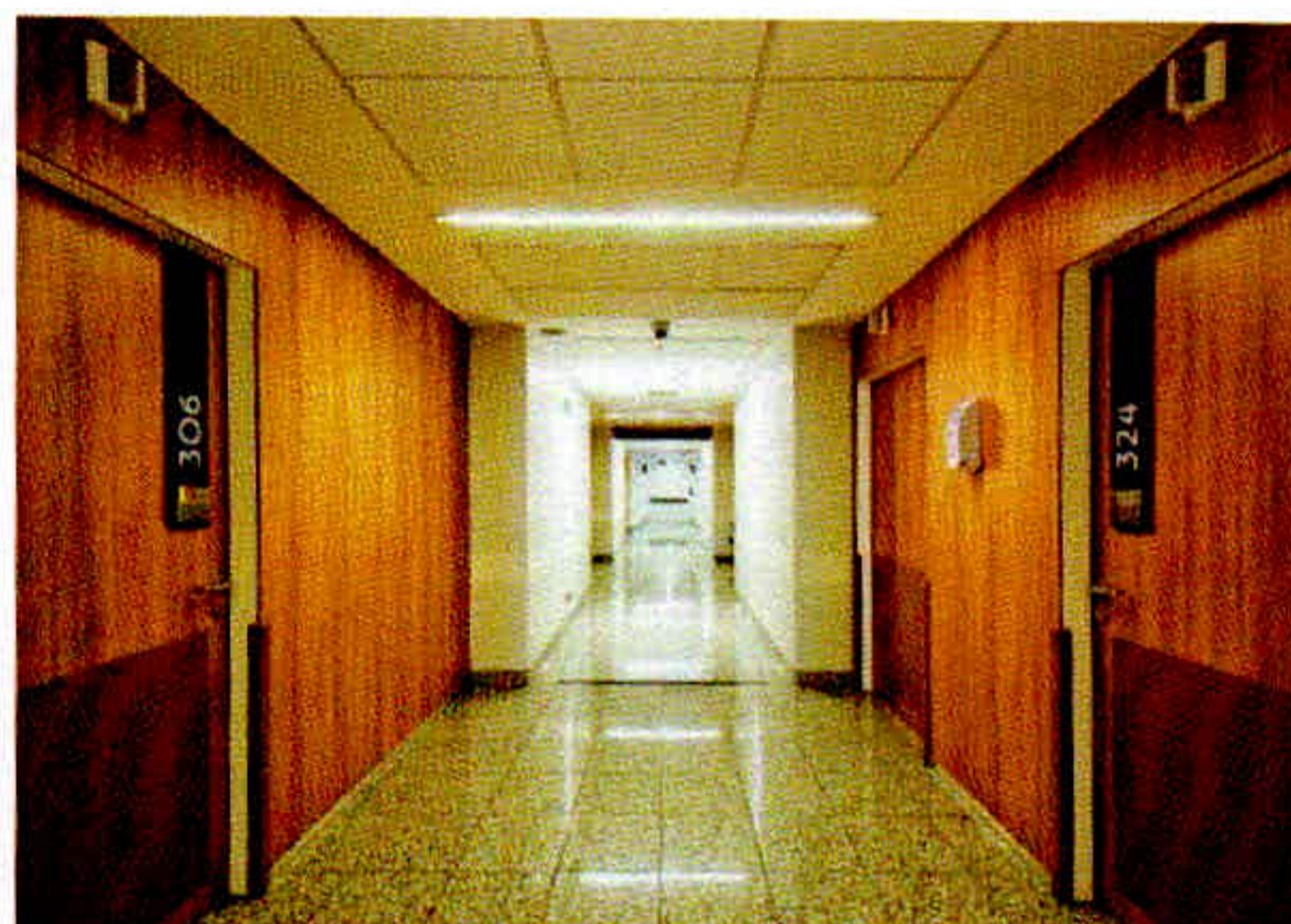
Figura 17 – Corredor que permite passagem de cadeira de rodas e macas. Fonte: http://arcoweb.com.br/projetodesign/arquitetura/raf-arquitetura-hospital-unimed-rio-janeiro . Acesso em: 18 de outubro de 2015.
