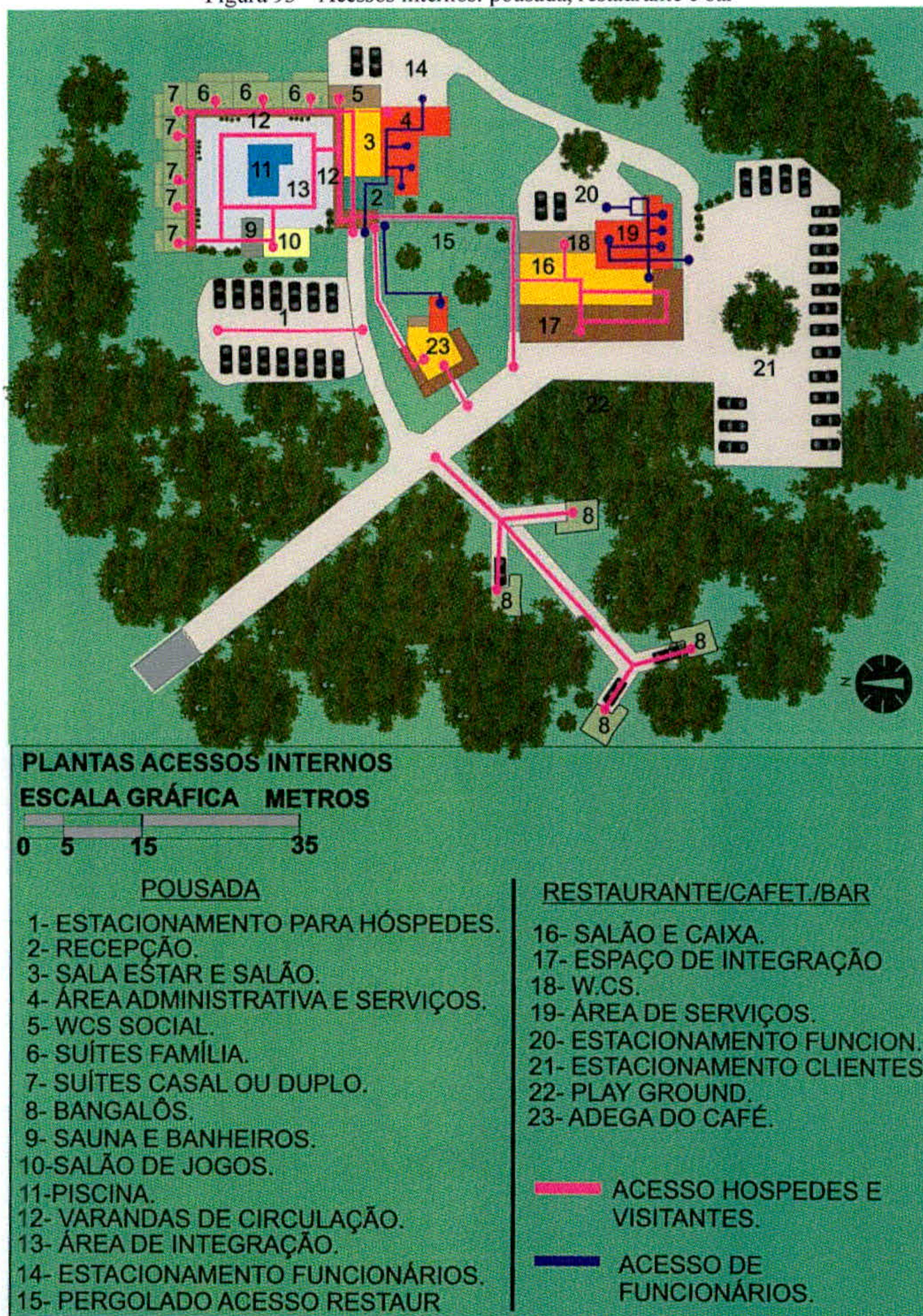
Figura 93 – Acessos internos: pousada, restaurante e bar
