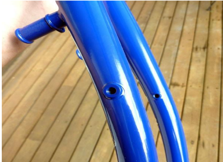
Figura 13 – Garfo em aço cromo molibdênio
