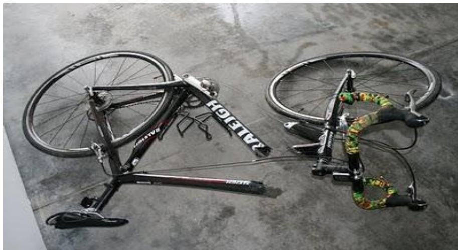
Fig. 17 - Quadro em fibra de carbono com rompimento total
