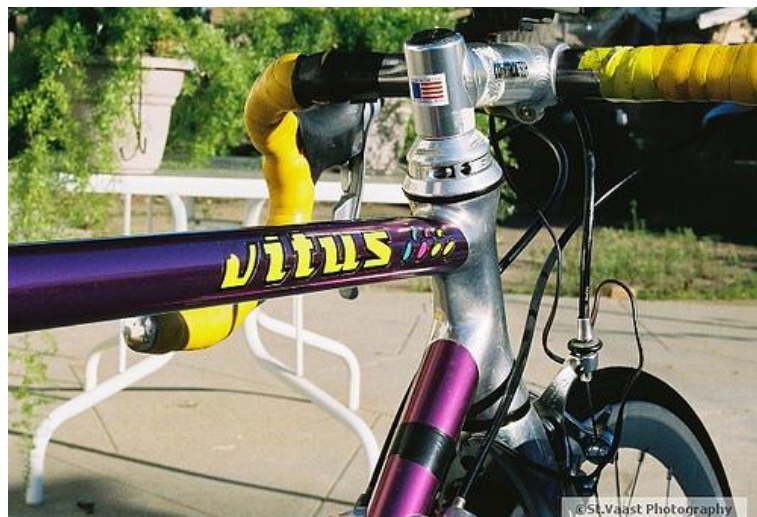
Figura 14 – Quadro cachimbado em liga de alumínio
