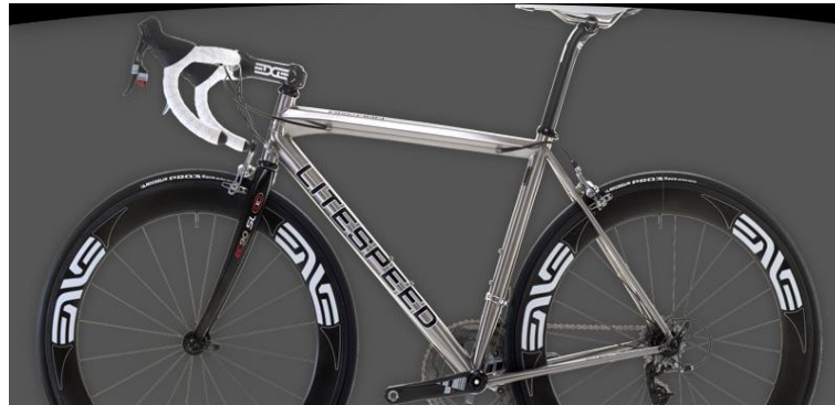
Figura 15 - Quadro construído em titânio
