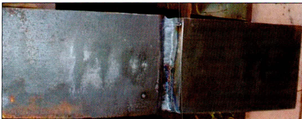
Figura 3.16 – CP 02 com passe de raiz preparado pelo soldador sem qualificação. Fonte: Fabrício, 2011.
