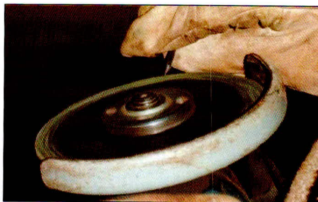
Figura 3.14 – Preparação do eletrodo de tungstênio.
