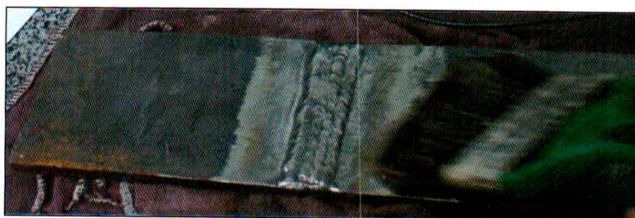
Figura 3.22 – Aplicação do acoplante no corpo de prova.
