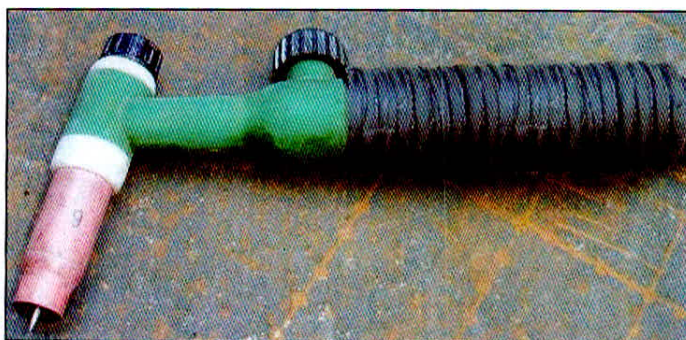
Figura 3.3 – Foto da tocha com bico cerâmico e bico de tungstênio. Fonte: Fabrício, 2011.
