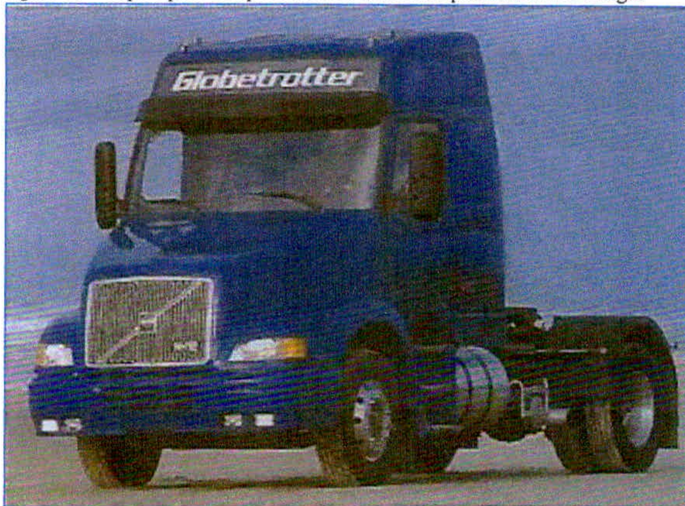
Figura 18 – Capô e para-choque fabricado através do processo de RTM light
