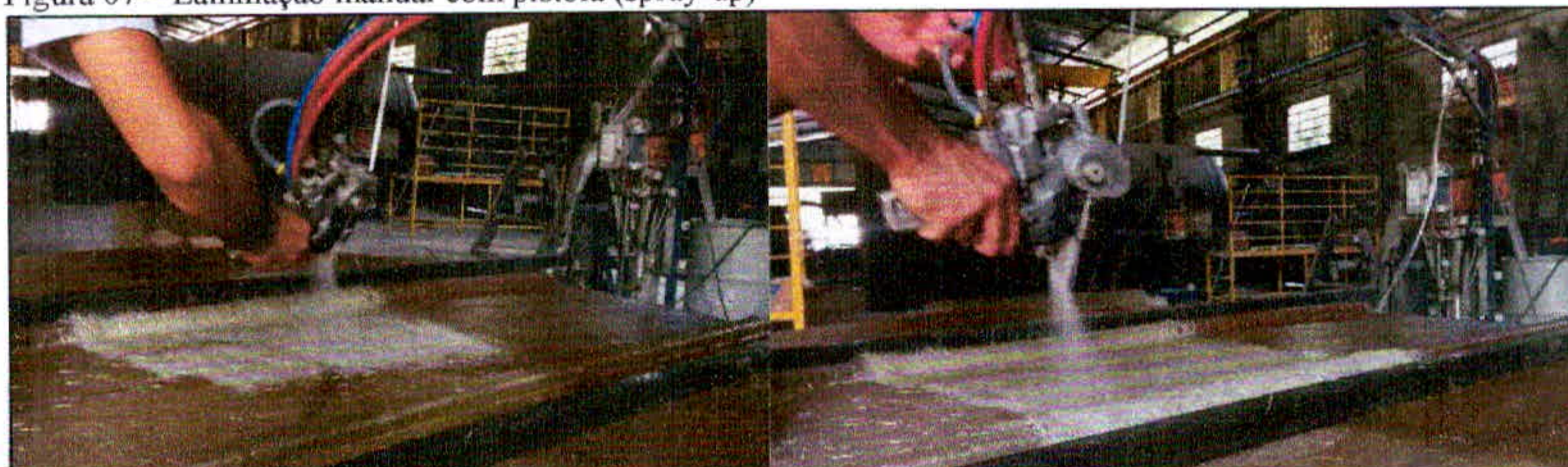
Figura 07 – Laminação manual com pistola (spray-up)
