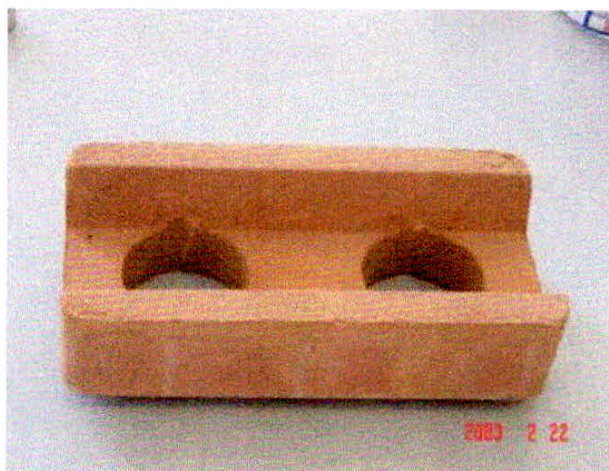
Figura 9 - Tijolo de solo-cimento tipo canaleta para a execução de vergas e cintas de amarração.
