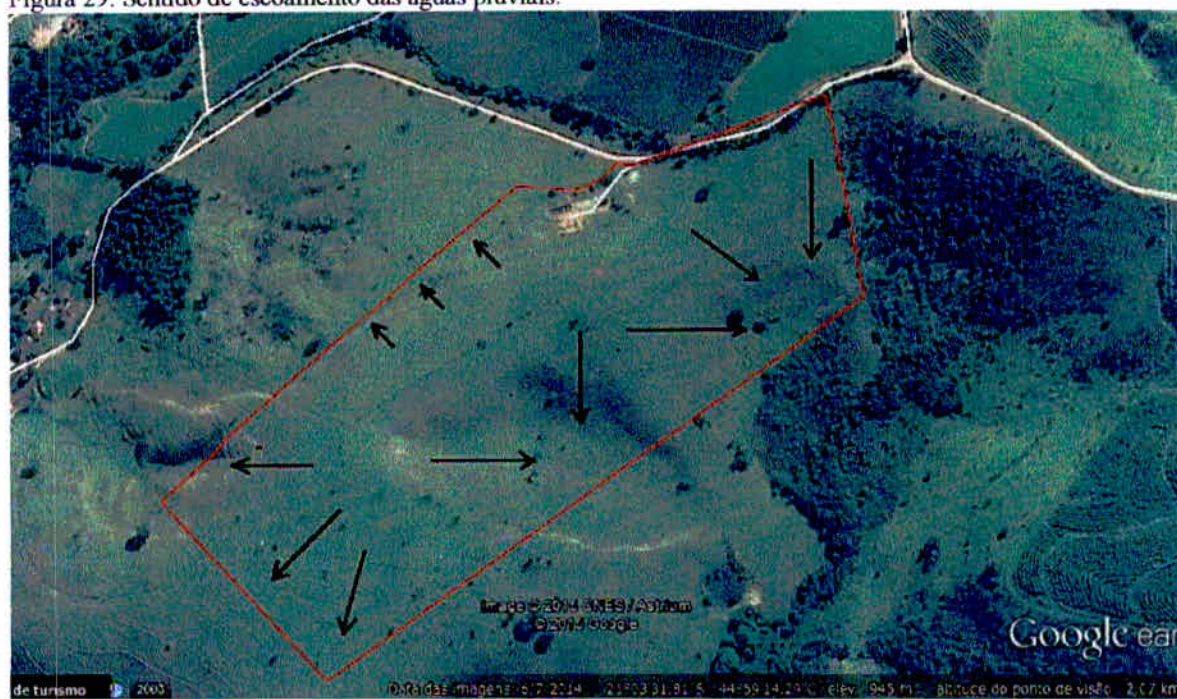
Figura 29: Sentido de escoamento das águas pluviais.
