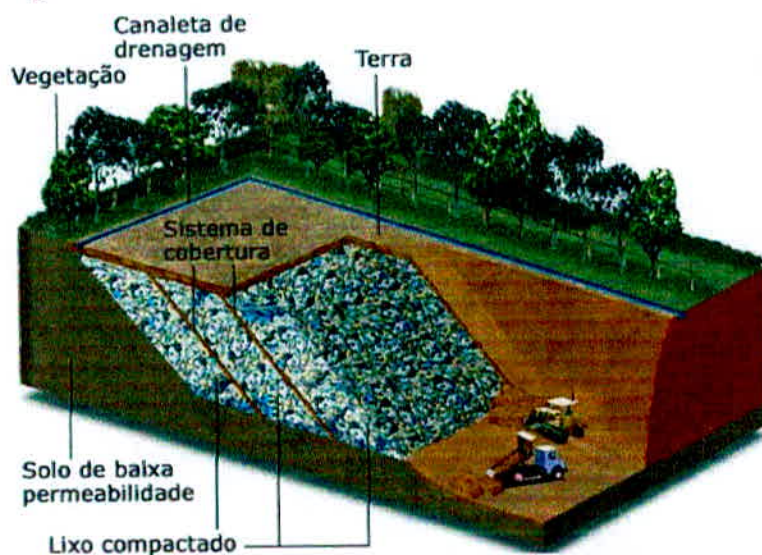
Figura 16: Aterro Sanitário em Vala
