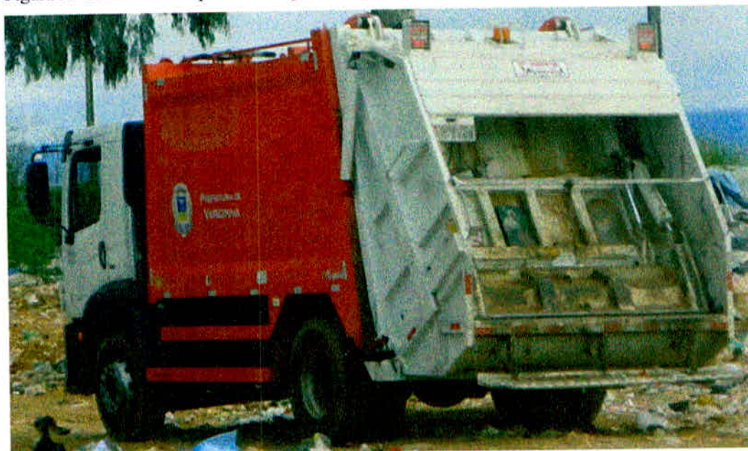
Figura 9: Caminhão compactador responsável pela coleta de resíduos sólidos.
