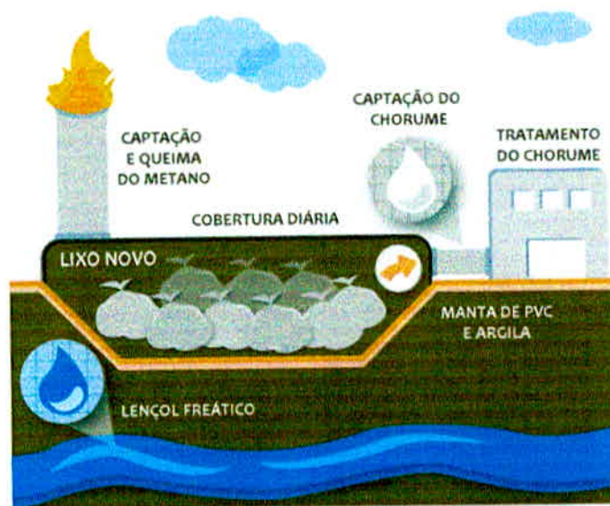
Figura 15: Modelo de Aterro Sanitário
