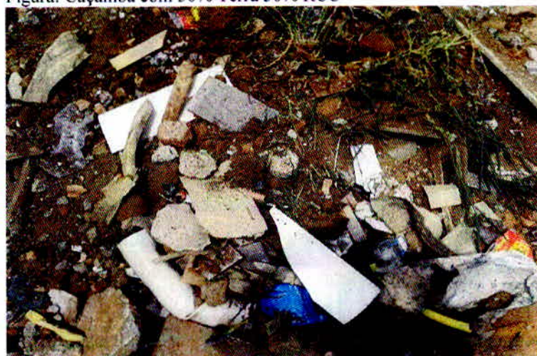
Figura: Caçamba com 50% Terra 50% RCC
