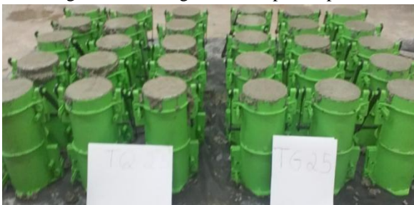
Figura 22-Moldagem dos corpos de prova
