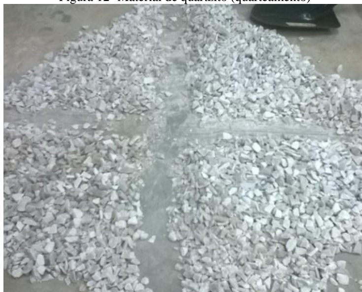
Figura 12- Material de quartzito (quartejamento)
