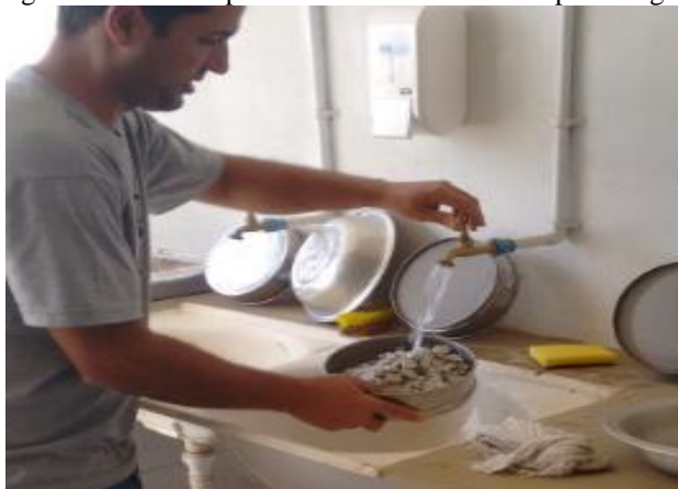
Figura 19-Material pulverulento sendo retirado por lavagem
