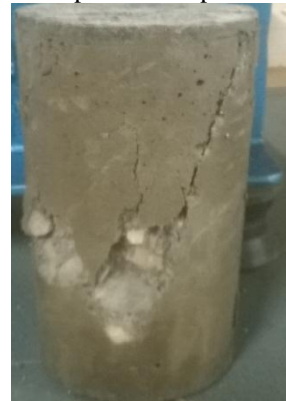
Figura 25-Ruptura à compressão TQ 30
