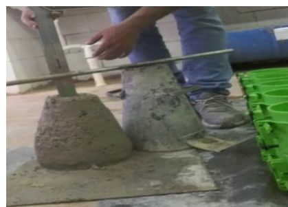
Figura 26-Ensaio de abatimento de tronco de cone
