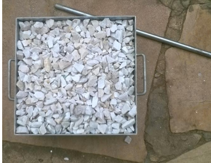
Figura 18-Realização ensaio de massa unitária
