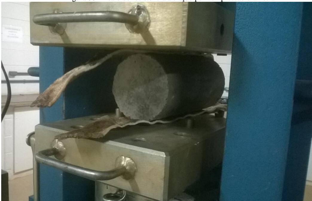
Figura 33-Ensaio de resistência à tração por compressão diametral
