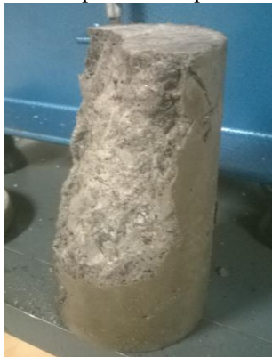
Figura 32-Ruptura à compressão TG 30
