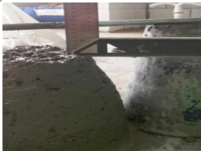
Figura 25-Ensaio de abatimento de tronco de cone
