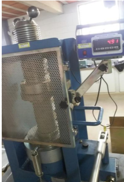
Figura 27-Prensa utilizada para ensaio de resistência a compressão
