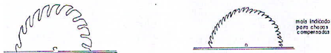
Figura 12 - Tipos de discos para cortes de tábuas e chapas compensadas.
