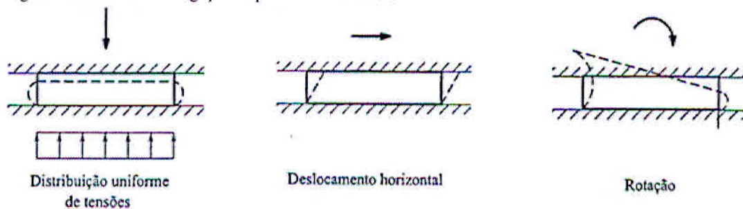
Figura 66 - Recurso nas ligações: apoios de elastômero
