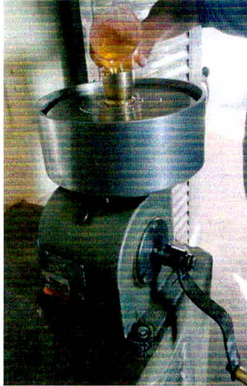
Figura 11 - Solvente sendo colocado no interior do prato.
