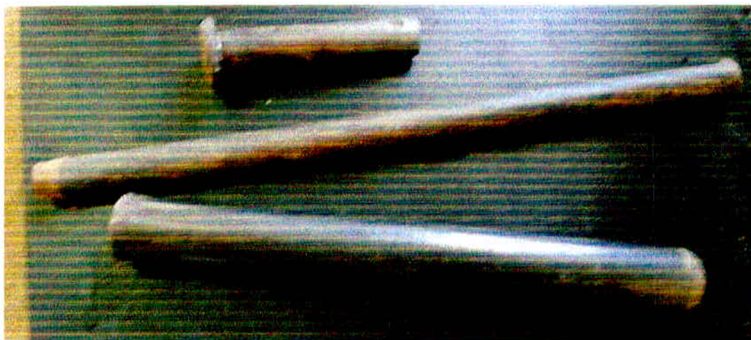
Figura 14 - Amostrador tipo Shelby utilizado na extração da camada de base.
