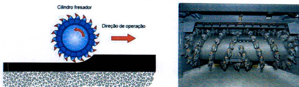
Figura 32 - Disposição dos bits e tambor rotativo para moagem.
