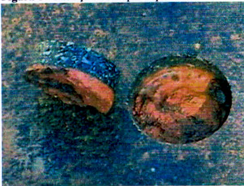
Figura 8 - Extração de corpo de prova.
