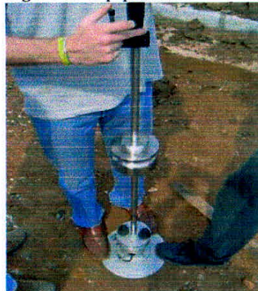
Figura 12 - Equipamento DCP em uso.
