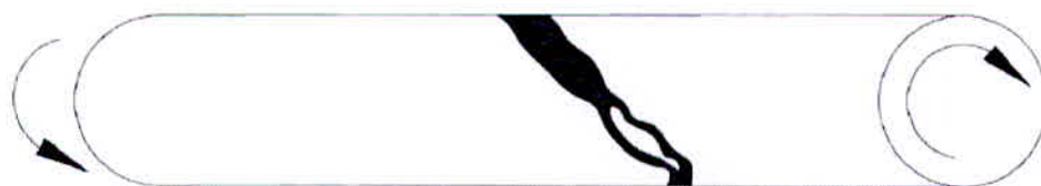
Figura 8 – Fissuras de torção.
