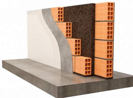
Figura 04: Parede com lã de rocha
