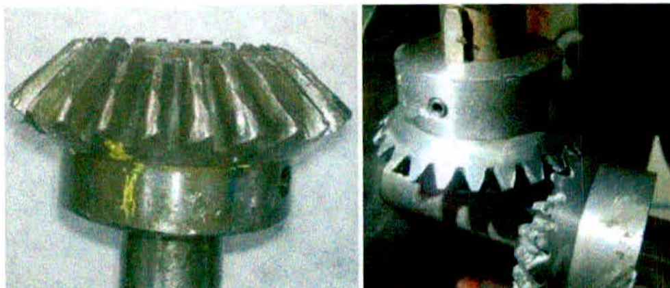
Figura 14: Engrenagens de transmissão antes e depois do reprojeto com o mesmo tempo de uso. Fonte: O autor.
