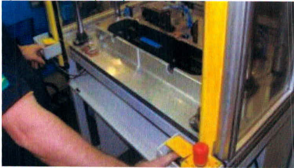
Figura 09 – Acionando o dispositivo para o cravamento das bóculas
