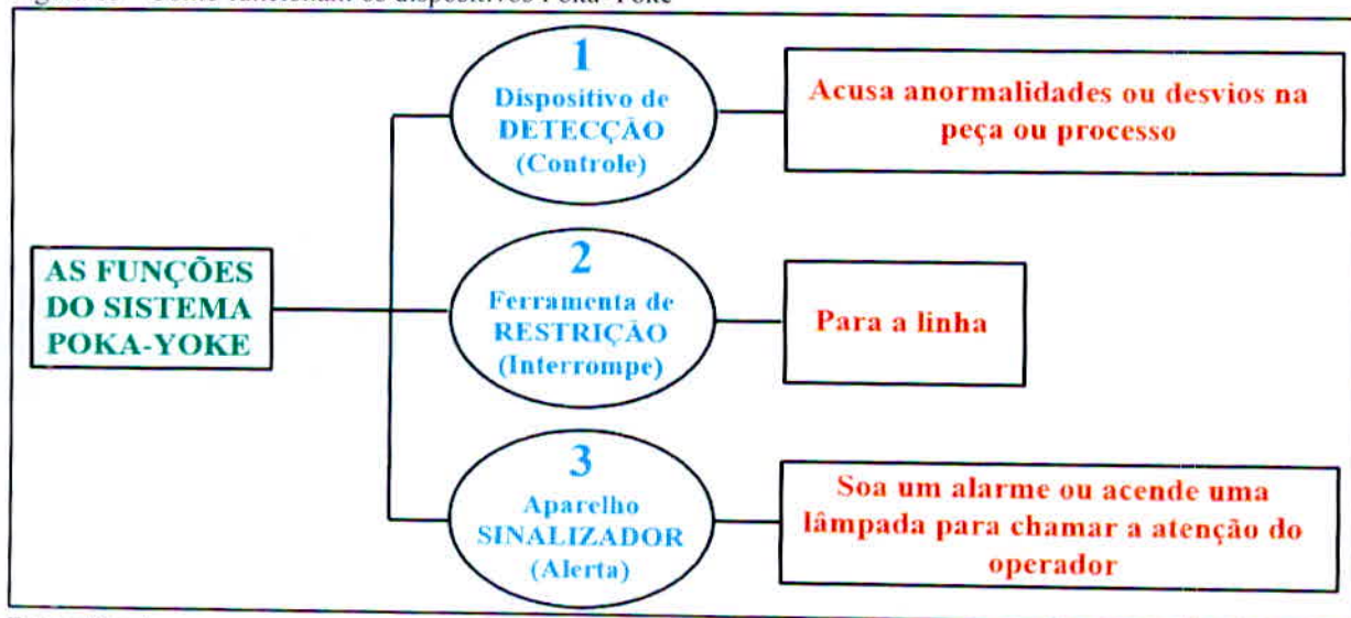
Figura 03 - Como funcionam os dispositivos Poka-Yoke
