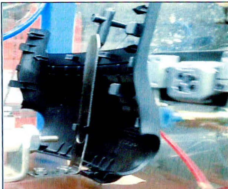
Figura 22 - Produto acoplado no dispositivo Poka-Yoke
