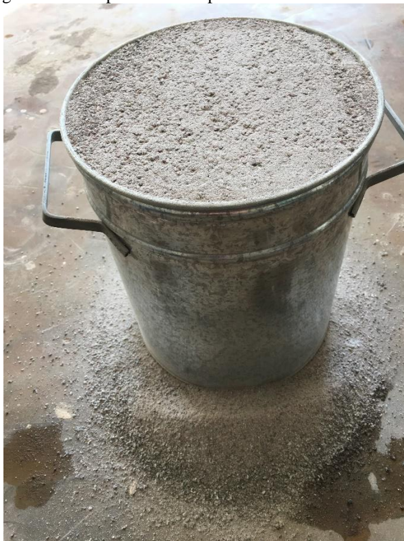
Figura 22 - Recipiente rasado para ensaio de massa unitária.
