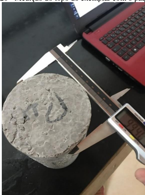
Figura 20 - Medição do topo do exemplar com o paquímetro.
