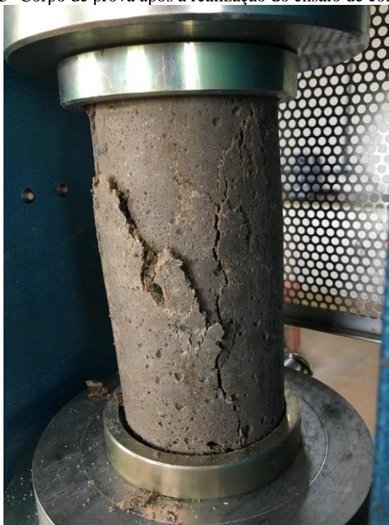
Figura 15- Corpo de prova após a realização do ensaio de compressão.
