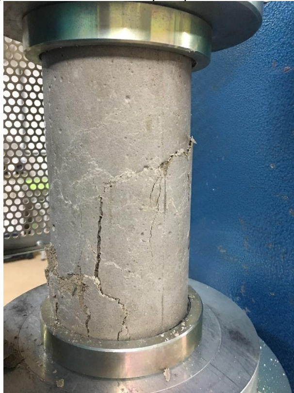
Figura 24 - Cisalhamento do corpo de prova colhido na obra 10.
