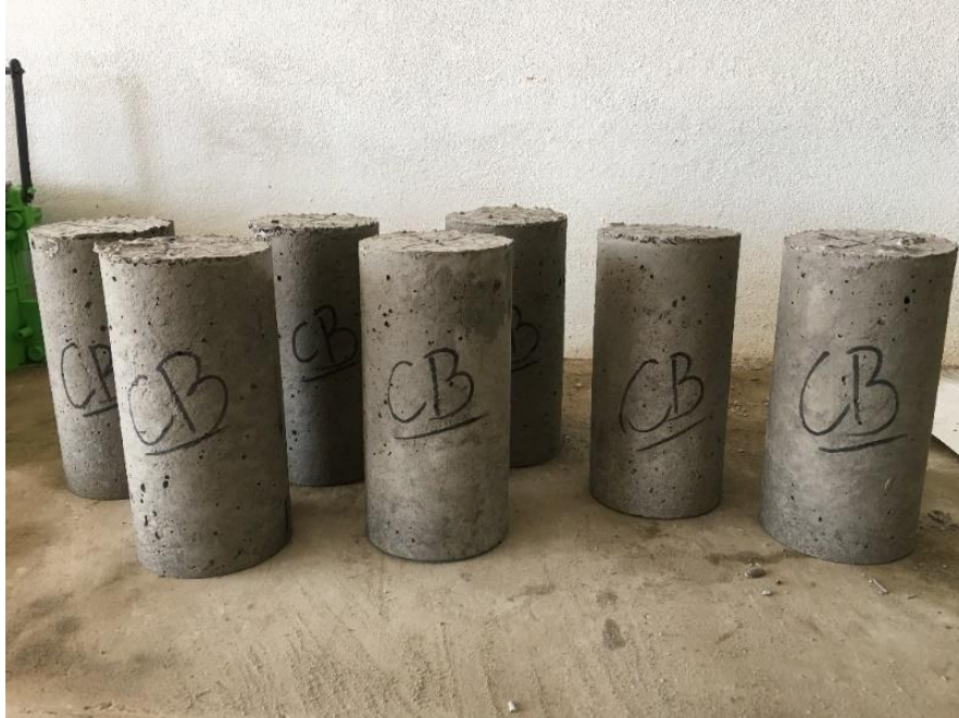
Figura 18 - Corpos de prova de concreto moldados.
