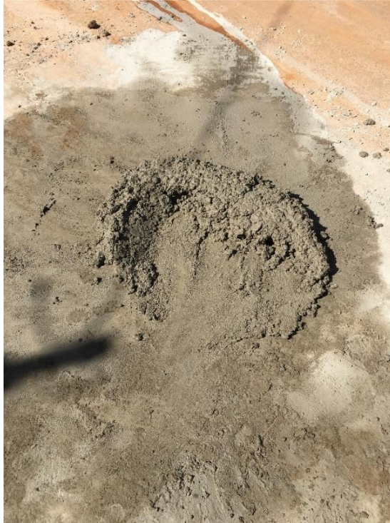
Figura 9 - Concreto produzido manualmente.
