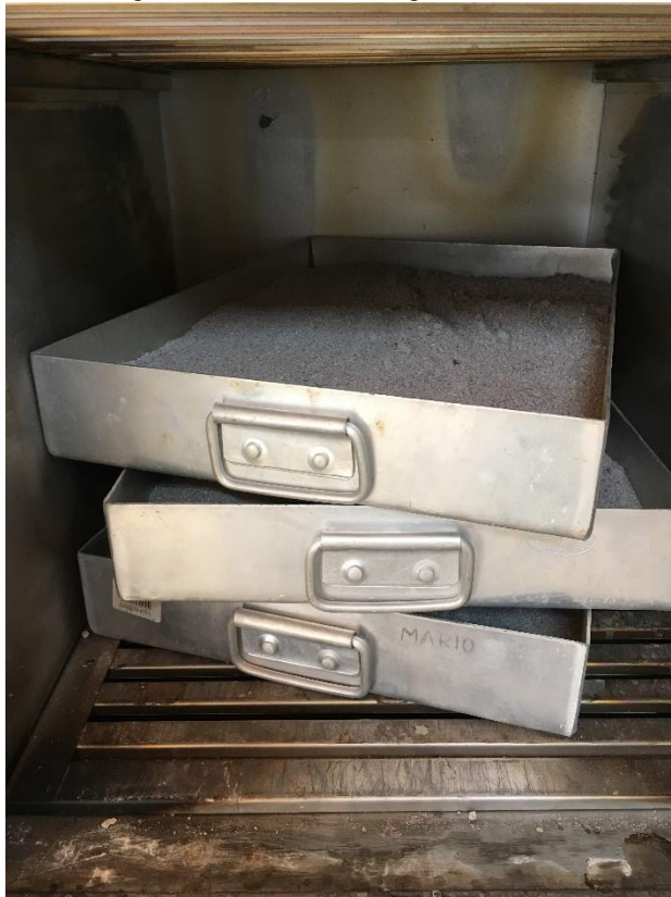
Figura 21 - Areia em secagem na estufa.
