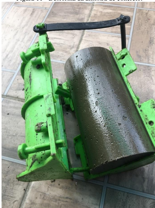
Figura 11 - Desforma da amostra de concreto.
