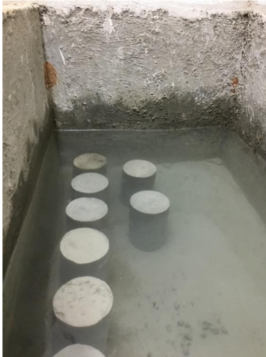
Figura 13 - Amostras de concreto em cura saturada na câmara úmida.
