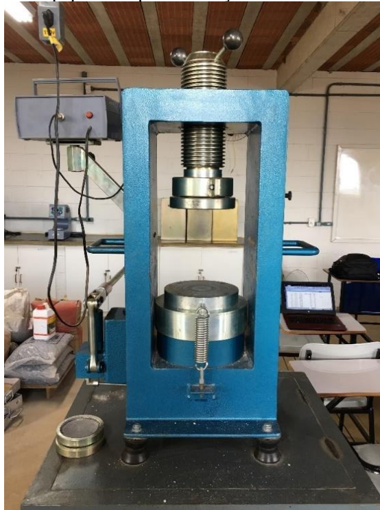
Figura 14 - Equipamento para realização do ensaio de compressão.
