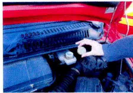
Figura 8: Nível do líquido dos freios na viatura.
