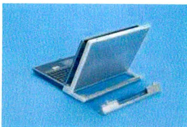
Figura 11 – Laptop da Fujitsu com célula a combustível.
